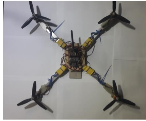
Fotoğraf 2.4. Öğrencilerin yaptığı RF kumanda ve Quadcopter [26]
