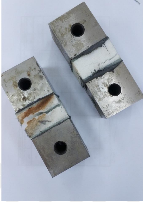
Şekil 4.4 Çekme testi sonrası numuneler (Kişisel arşiv, 2018)
