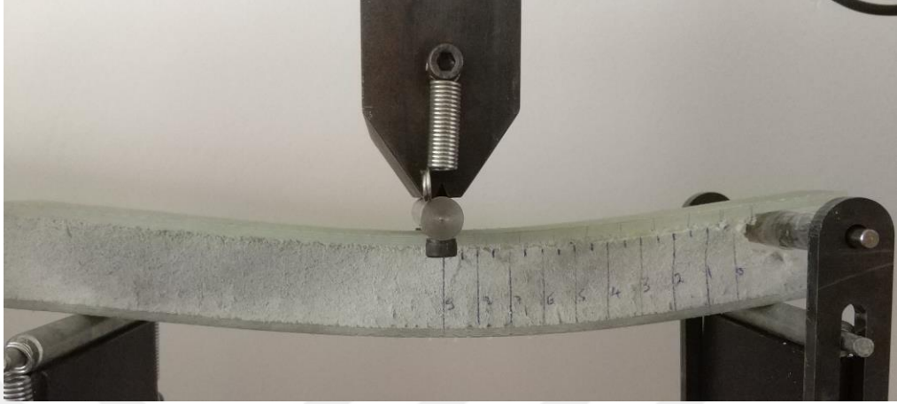
Şekil 4.25 MCSB testinde numuneye uygulanan kuvvet etkisiyle oluşan eğilme (Kişisel arşiv, 2018)
