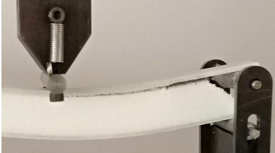
Şekil 4.26 MCSB testinin sonucundaki çatlak ilerleyişi (Kişisel arşiv, 2018)
