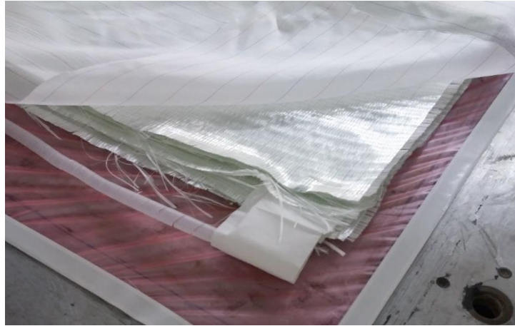
Şekil 2.2 Vakum spiral hortum ve kumaş katmanların görünümü (Kişisel arşiv, 2016)
