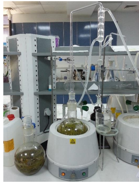
Görsel 3.4. Clevenger apareyinde hidrodistilasyon işlemi (Foto: Yelbaşı, 2019)
