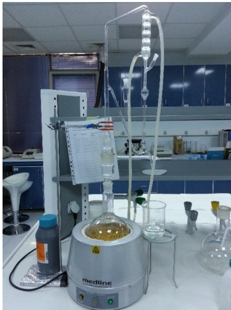
Görsel 3.4. Clevenger apareyinde hidrodistilasyon işlemi (Foto: Yelbaşı, 2019)
