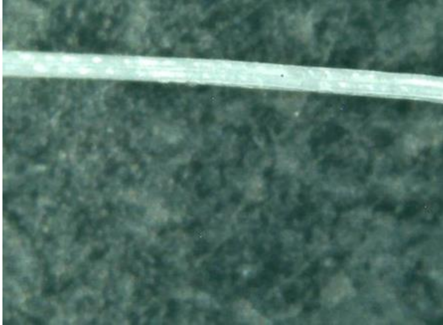
Şekil 12.6. 40 Denye yumuşak elastan büyüteç görüntüsü. Ölçek: 1/150
