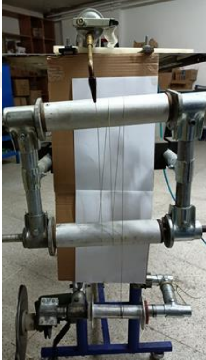
Şekil 13.1. Sentezlenmiş polimerin iplik haline getirilmesi düzeneği-a
