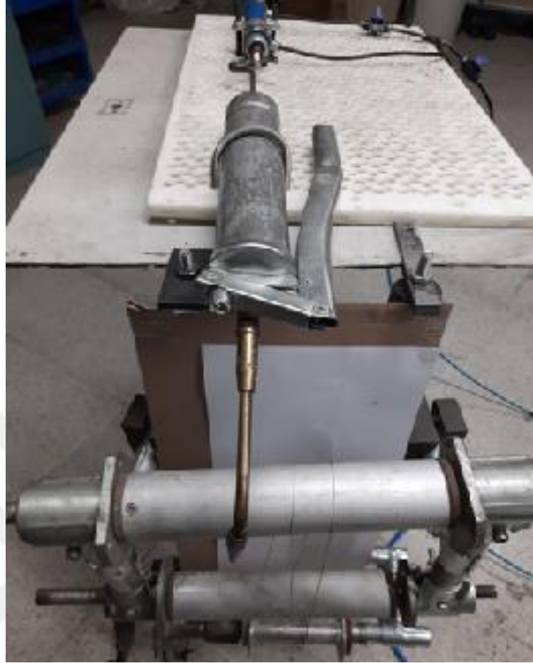
Şekil 13.2. Sentezlenmiş polimerin iplik haline getirilmesi düzeneği-b
