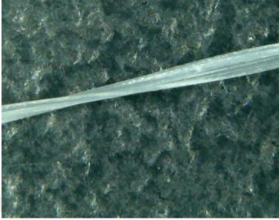
Şekil 12.7. 40 Denye sert elastañ büyüteç görüntüsü. Ölçek: 1/150
