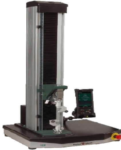
Şekil 4.2. Sabit hızlı kopma mukavemeti test cihazı (www.tiniusolsen.com)
