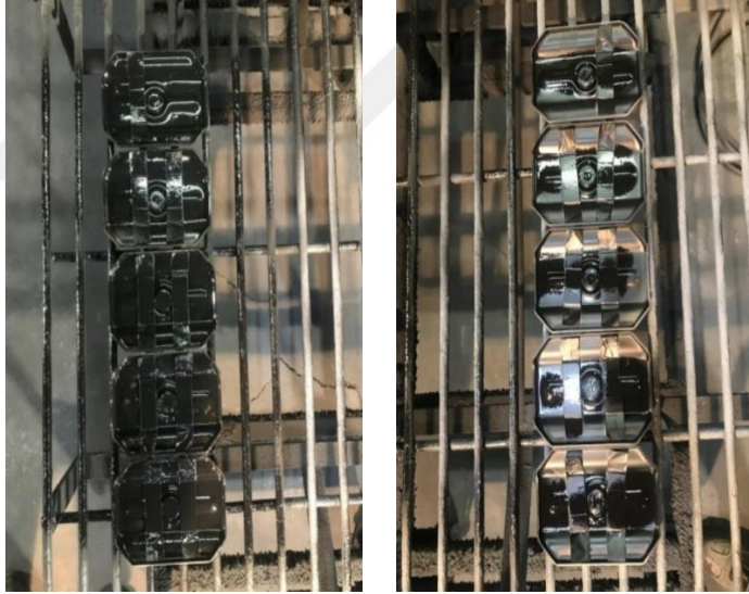
Resim 3.5. Yapıştırıcı Uygulamasının Yapılması. (Chemosil NL222, Chemosil 411)
