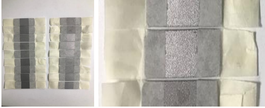
Resim 3.3. Maskeleme Yapılmış Metal Numuneler
