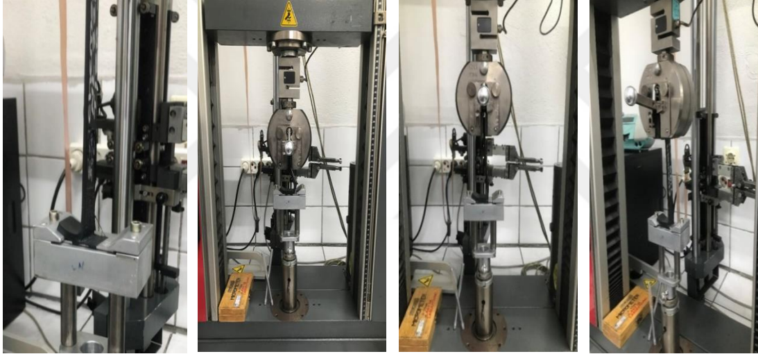
Resim 3.10. DIN EN ISO 527-1'e Göre Yapışma Kontrol Testleri
