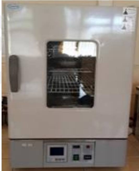
Şekil 5.4. Peletlerin kurutulduğu sirkülasyonlu etüv
