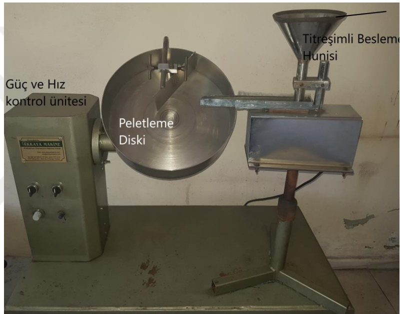
Şekil 5.2. Laboratuvar ölçekli peletleme diski
