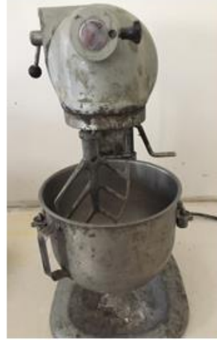
Şekil 9.8. Agrega ve bağlayıcı malzemelerin hobart mikserinde kuru karışımı
