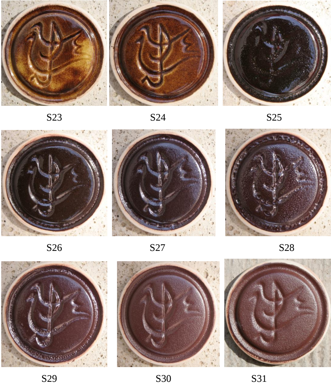
Şekil 7.15. Ticari firit -Uslu köyü kırmızı kil katkılı sırların 1160 °C 'deki pişme renkleri
