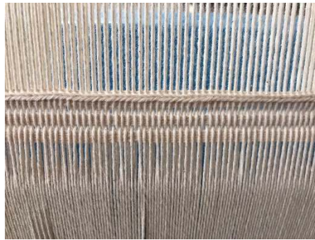
Resim 2.25. Çiti örgüsü, NEGSF Halı atölyesi (Kabalcı, 2022).
