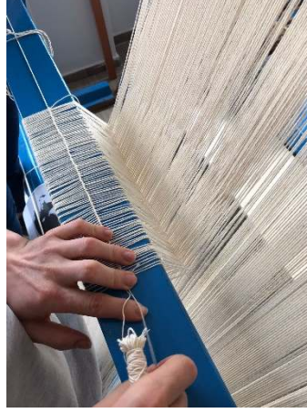
Resim 2.24. Gücöleme işlemi, NEGSF Halı atölyesi (Kabalcı, 2022).
