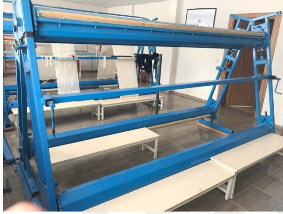
Resim 2.11. Hereke tipi metal sarma tezgâhı (Kabalıcı, 2022).
