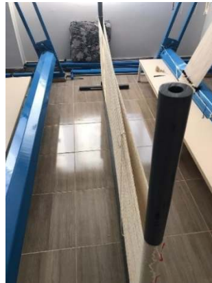
Resim 2.23. Çözügü aletiyle çözügü hazırlama işlemi, NEGSF Halı atölyesi (Kabalcı, 2022).
