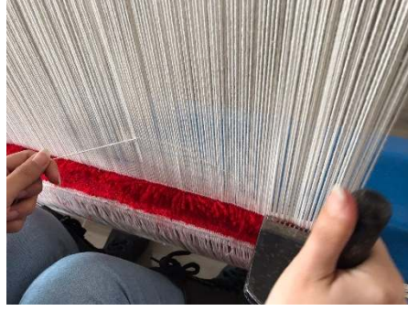
Resim 2.27. Süzme atkının kirkitle çözgüye yerleştirilmesi, NEGSF Halı atölyesi (Kabalcı, 2022).
