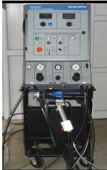
Şekil 5.2. Elektrik ark püskürtme cihazı.
