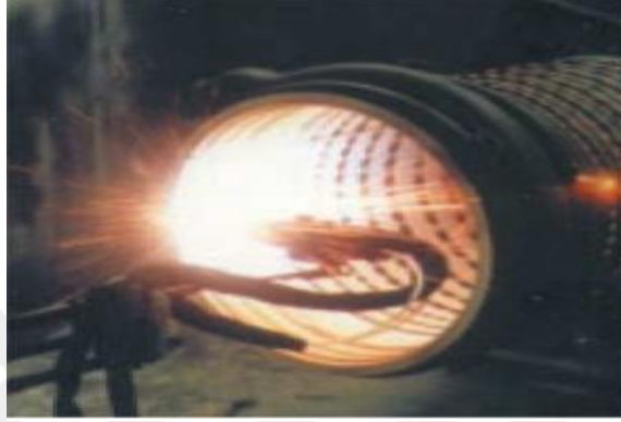
Şekil 3.9. Uçak motorunun tamir amaçlı kaplama uygulaması [40].
