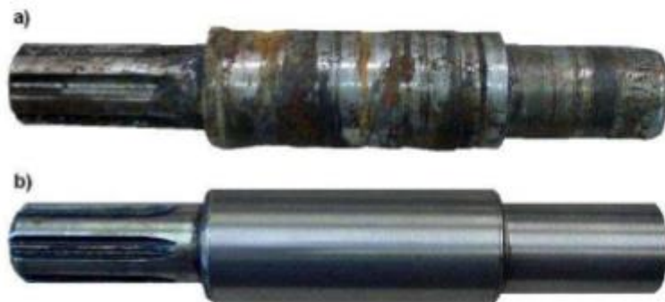
Şekil 3.8. a) İş parası yüzeyinde kullanım sırasında oluşan aşınma. b) Elektrik ark spreyle kaplanarak tamir edilmiş iş parası [35].
