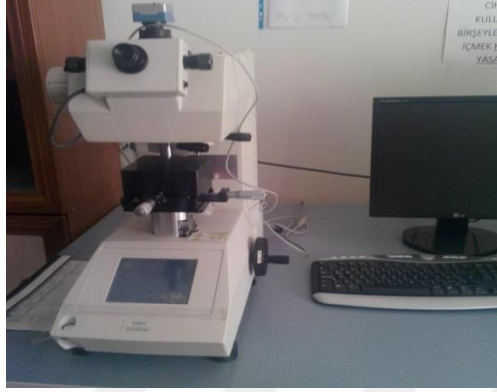
Şekil 5.4. Kullanılan sertlik cihazının resmi
