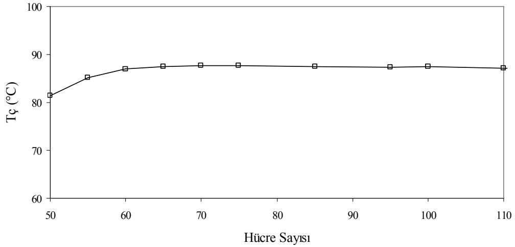
Şekil 5.2. Sabit ısı akısında hücre sayısı değişimi ile T_c ortalama kolektör çıkış sıcaklığının değişimi, ( H_k=1,7 m, R_k=120 m, D_b=10 m, H_b=195 m).
