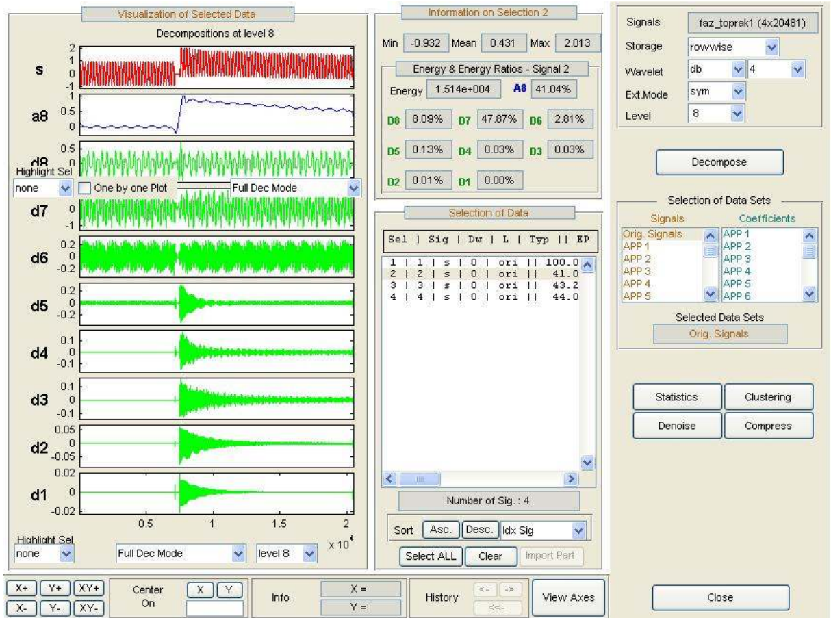
Şekil 5.7 Tek faz toprak kısa devresi dalga şeklinin Wavelet Toolbox ile dalgacık bileşenlerine ayrılması
