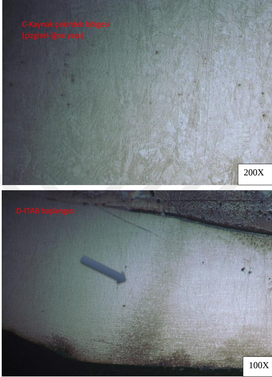
Şekil 8.15. (devam) DP 980-DP 980 kaynak çifti 11 kA-25 cycle için mikro yapı resimleri
