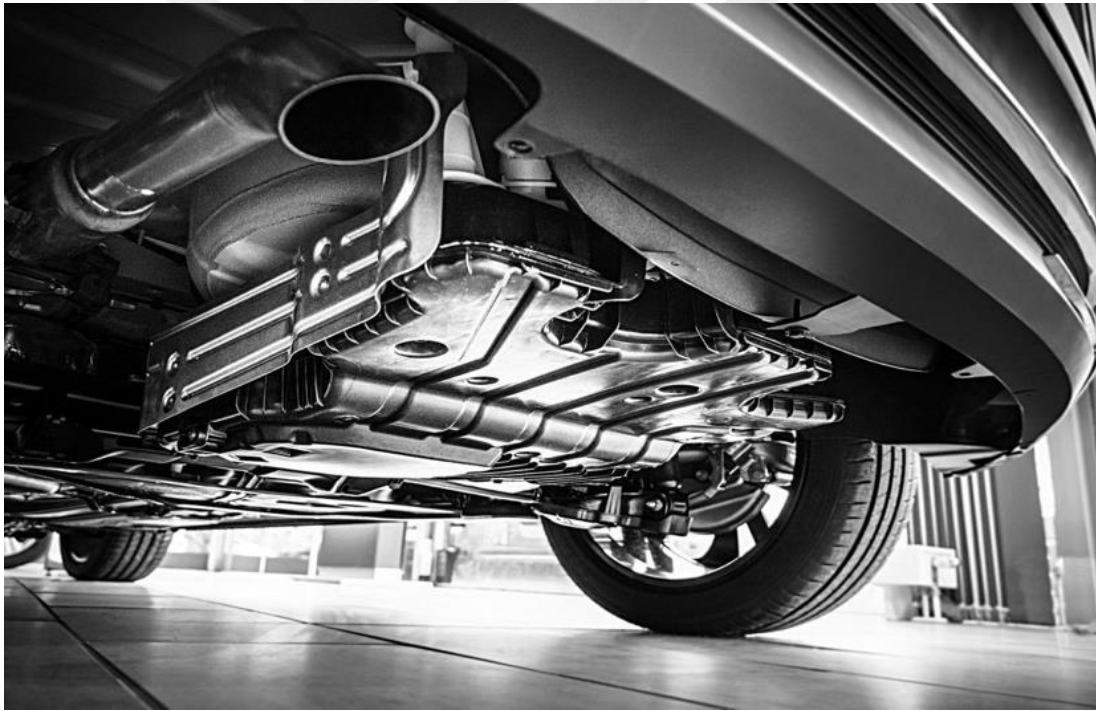
Şekil 4.4 Otomobil alt kısmında galvanizli çelik kullanım
