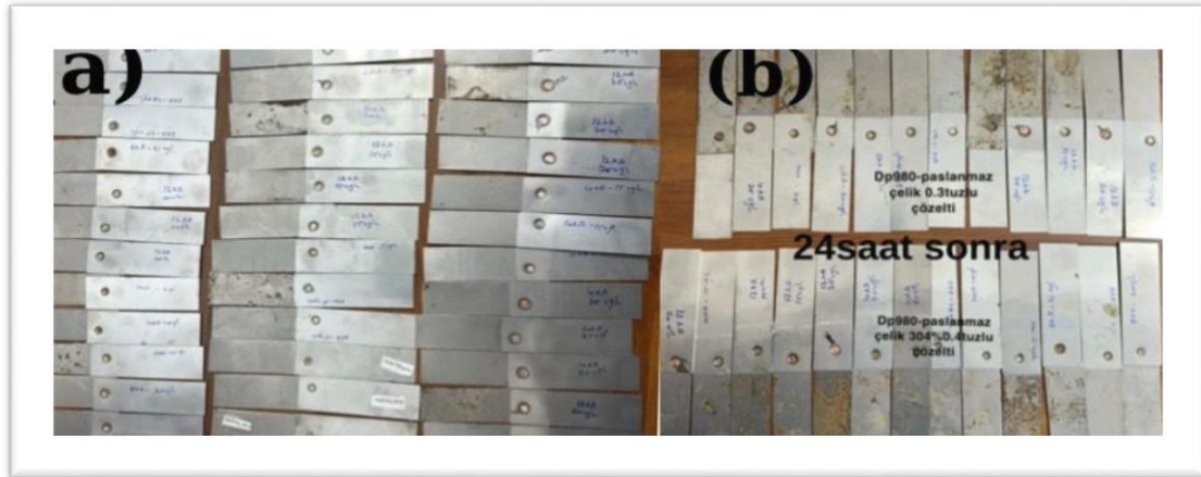
Şekil 7.6. AISI304/DP980 korozyon deneylerinden önce numuneler b)de AISI304/DP980 korozyon deneyinden sonra (%2,%3ve %4çözeltide)
