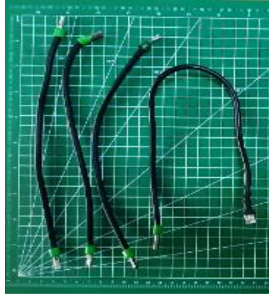
Şekil 3.9. Panoda kullanılan orijinal siyah renkli kablo.
