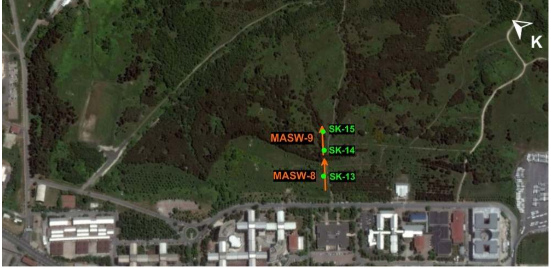
Şekil 5.23 MENZA binasının kuzeydoğusunda yapılan MASW çalışmalarının uydu görüntüsü üzerine yerleştirilmiş ölçüm planı.
