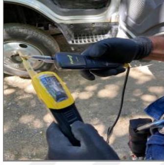
Şekil 2.12. Alçak gerilim (AG) enerji kontrol dedektörü
