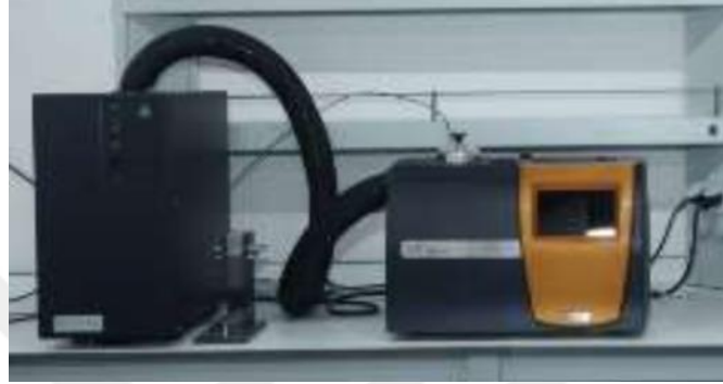
Şekil 4.9 : Diferansiyel taramalı kalorimetre cihazı (TA Instruments/DSC25).
