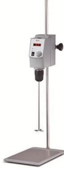
Şekil 4.2 : Mekanik karıştırıcı (DLAB/OS20-S).
