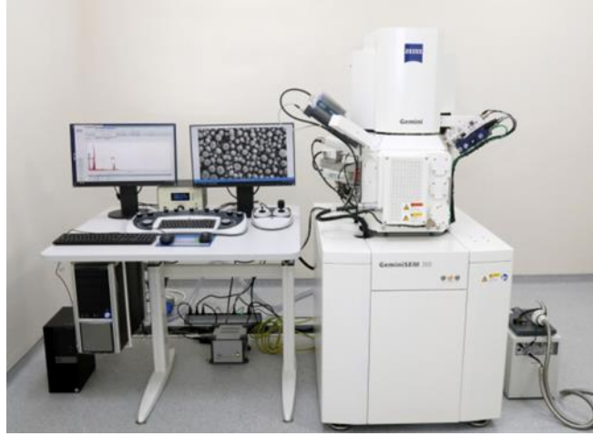
Şekil 4.6 : Taramalı elektron mikroskobu (Carl Zeiss/Gemini 300).
