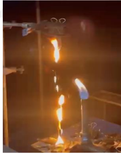
Şekil 5.16 : Saf PP, PP/hBN/SiC ve PP/Ti/hBN/Ti/SiC nanokompozitlerin dikey yanma/UL 94-V testindeki damlatma ve yanma görüntüleri.
