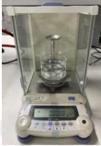
Şekil 4.4 : Hassas terazi uyumlu yoğunluk ölçüm kiti (Shimadzu/AUX321).
