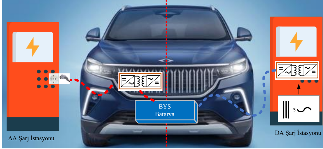
Şekil 1. EA'ların dahili ve harici şarj sistemleri
