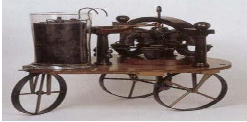
Şekil 2.1. Sibrandus Stratingh tarafından yapılan elektrik ile çalışan araç
