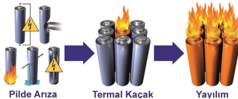
Şekil 2.5. Termal kaçak etkisi
