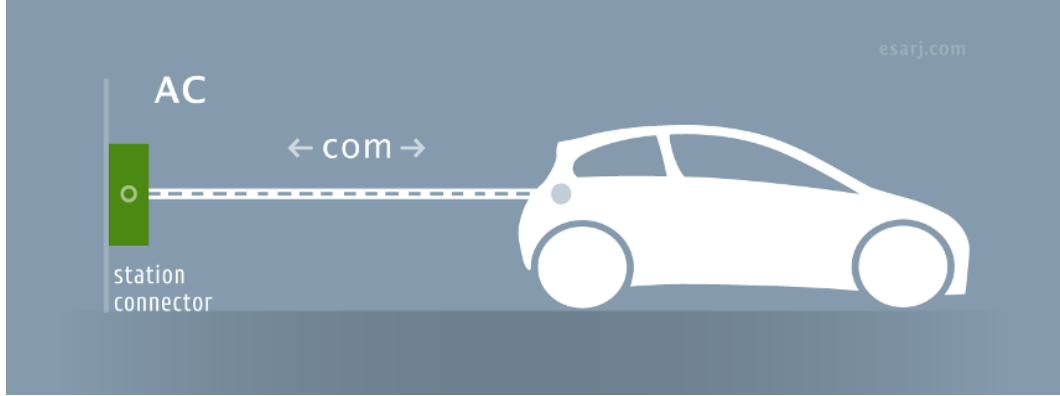
Şekil 5.4 Mod 3 şarj bağlantı gösterimi
