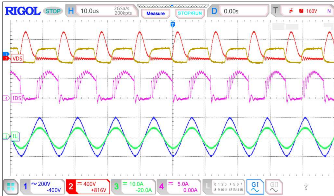
Şekil 7.10. 180,77 nF Kapasite değeri için 11 cm mesafede yük ve rezonans uyumsuzluğu grafiği
