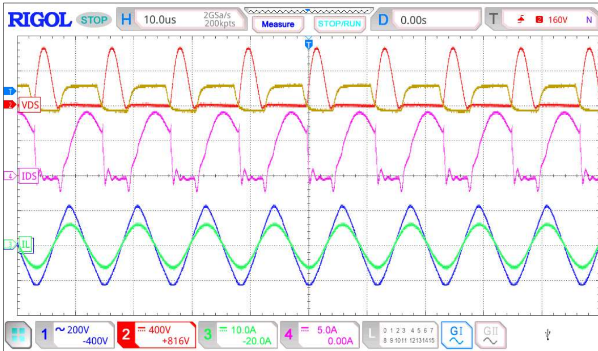
Şekil 7.12. 13 cm mesafe için 140,13 nF kapasitede V_{DS} , I_{DS} , V_L ve I_L grafiği
