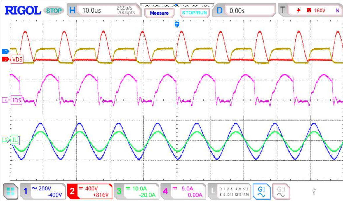
Şekil 7.7. 12 cm mesafe için 180,77 nF kapasitede V_{DS} , I_{DS} , V_L ve I_L grafiği
