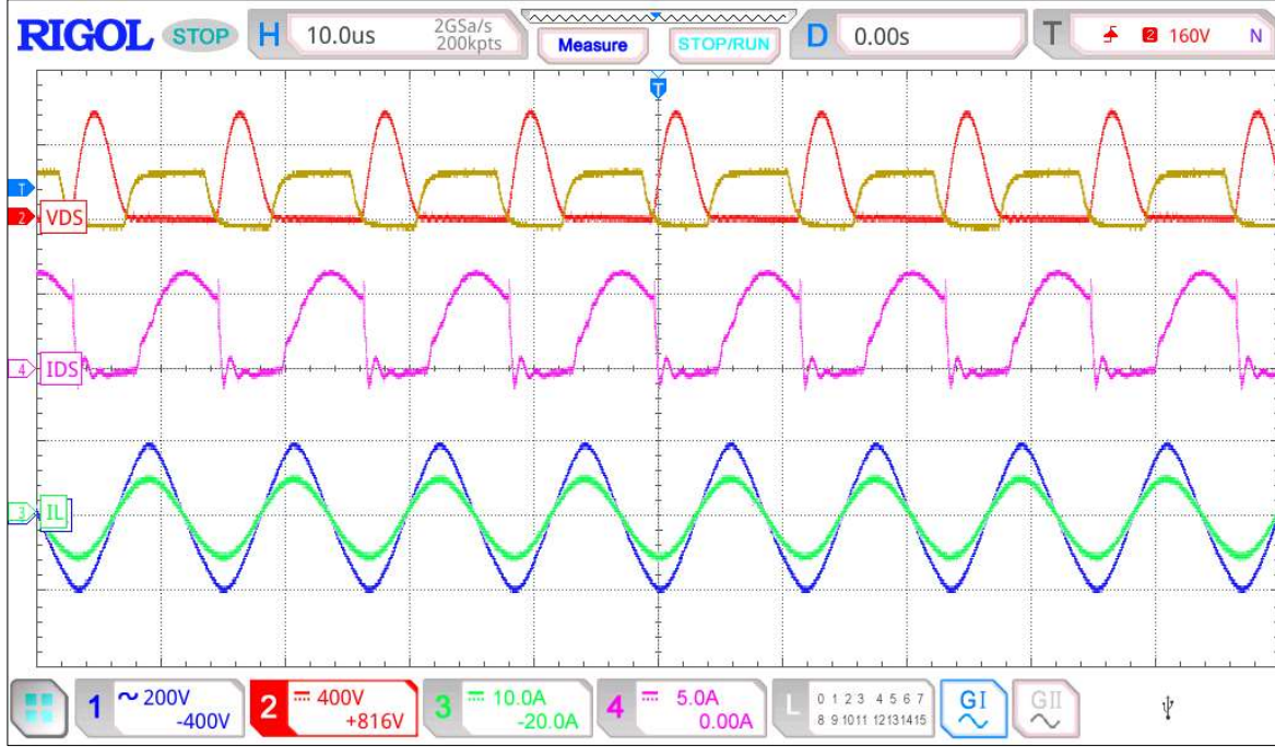
Şekil 7.2. 11 cm mesafe için 201,9 nF kapasitede V_{DS} , I_{DS} , V_L ve I_L grafiği
