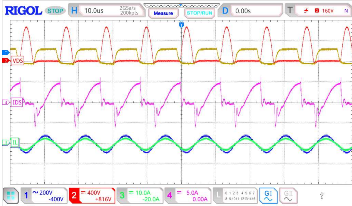
Şekil 7.6. 210,97 nF Kapasite değeri için 19 cm mesafede drain akımının bozulması
