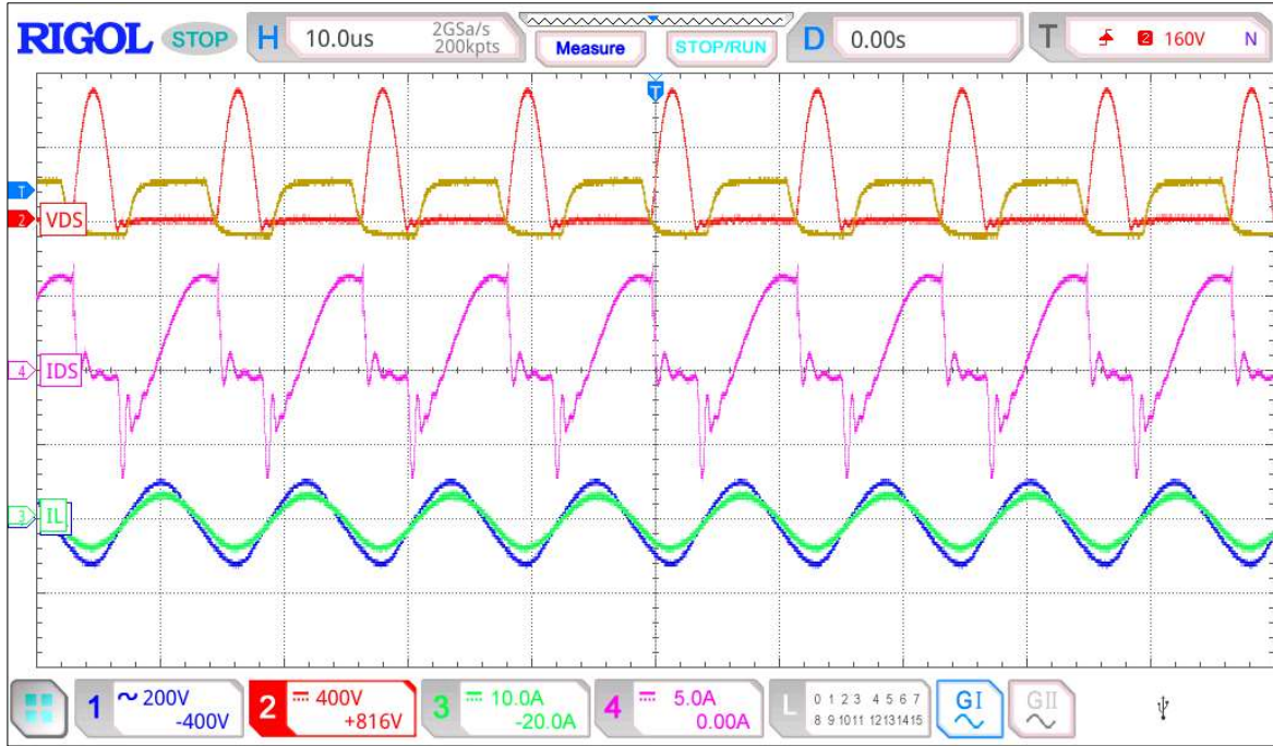
Şekil 7.16. 140,13 nF Kapasite değeri için 19 cm mesafede drain akımının bozulması
