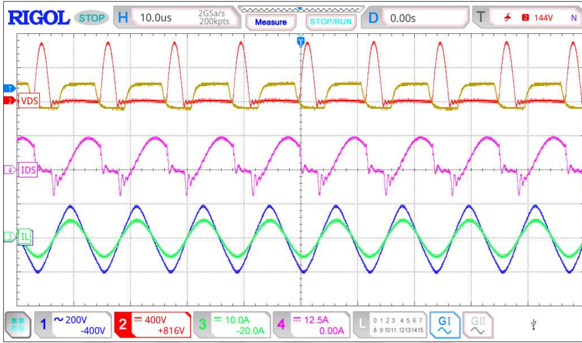
Şekil 7.31. 98,14 nF Kapasite değeri için 19 cm mesafede drain akımının bozulması
