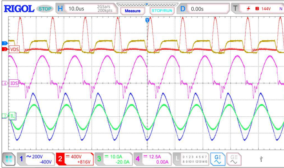
Şekil 7.41. 86,56 nF Kapasite değeri için 20 cm mesafede drain akımının bozulması
