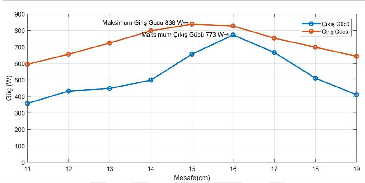
Şekil 7.28. 16 cm mesafe için 98,14 nF kapasitede maksimum giriş gücü ve maksimum çıkış gücü değişimi
