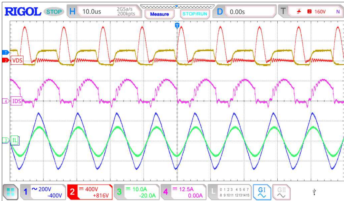
Şekil 7.22. 15 cm mesafe için 102,83 nF kapasitede V_{DS} , I_{DS} , V_L ve I_L grafiği
