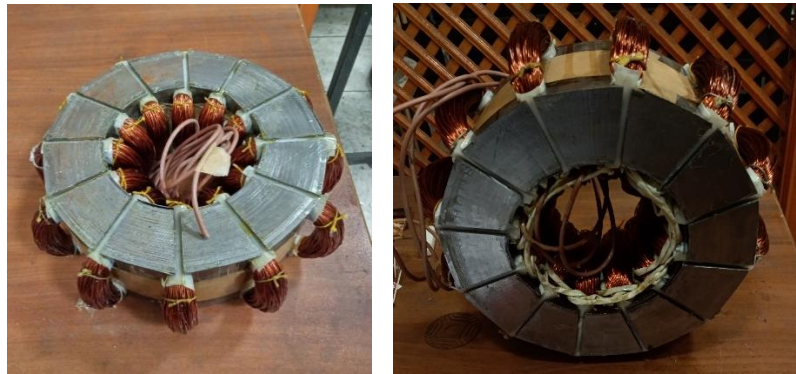
Şekil 5.5. Sargıları sarılmış stator
