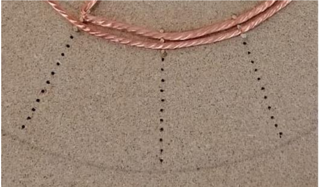
Şekil 5.10 Sarım kalıbı için oluşturulan klavuz çizgiler.
