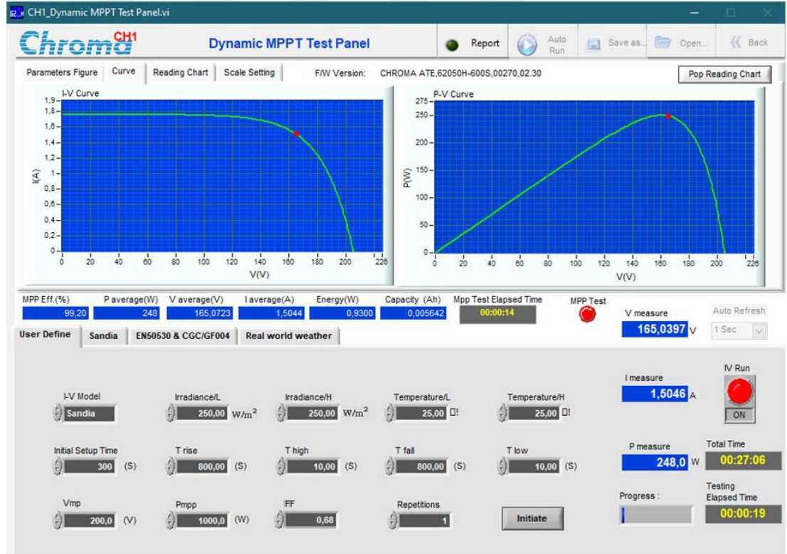
Ş ekil 6.19 250W/m 2 ışı nım deęerinde Düzensiz PDM için MPPT verimi
