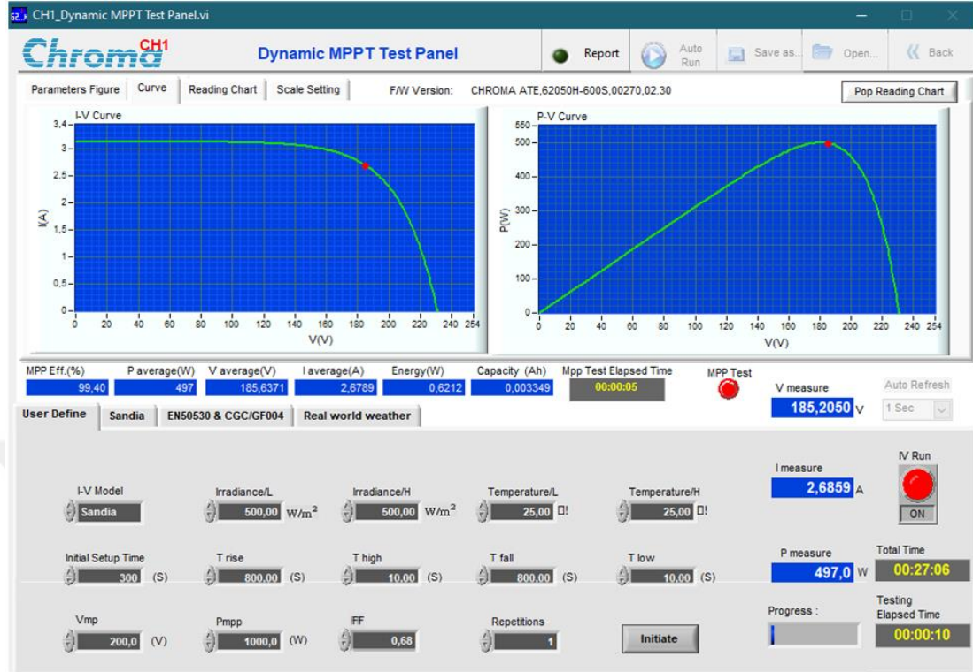
Şekil 6.25 500W/m^2 ışınım değerinde Düzensiz PDM için MPPT verimi
