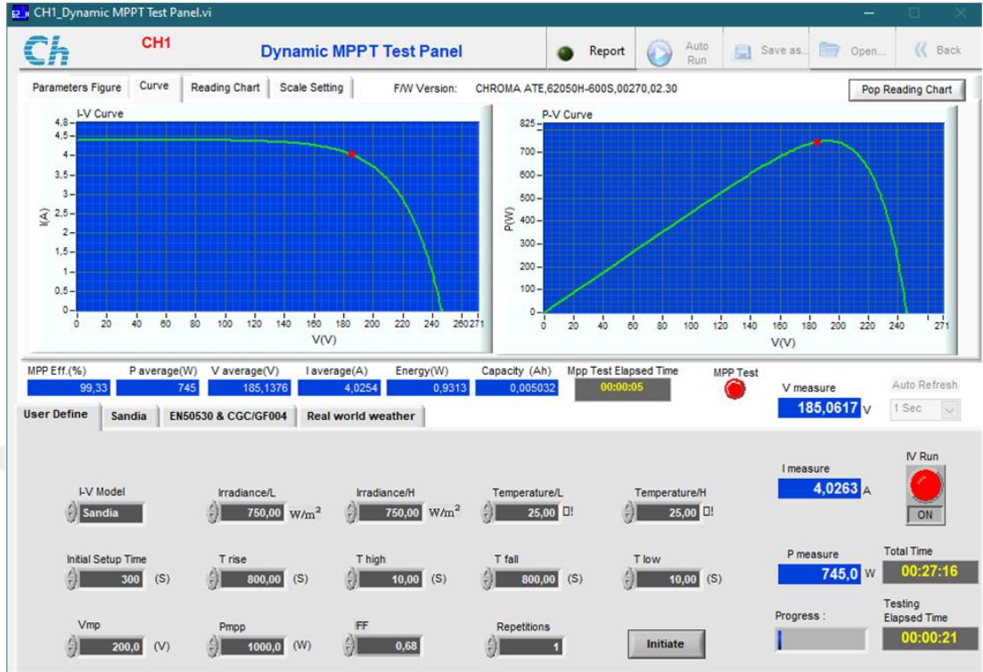
Şekil 6.31 750\text{ W/m}^2 ışınnm değerinde düzensiz PDM için MPPT verimi
