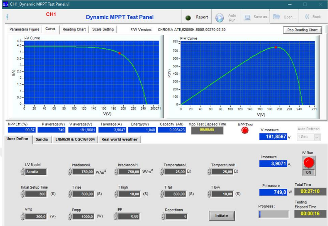
Şekil 6.35 750\text{ W/m}^2 ışınlm değerinde IPDM için MPPT verimi
