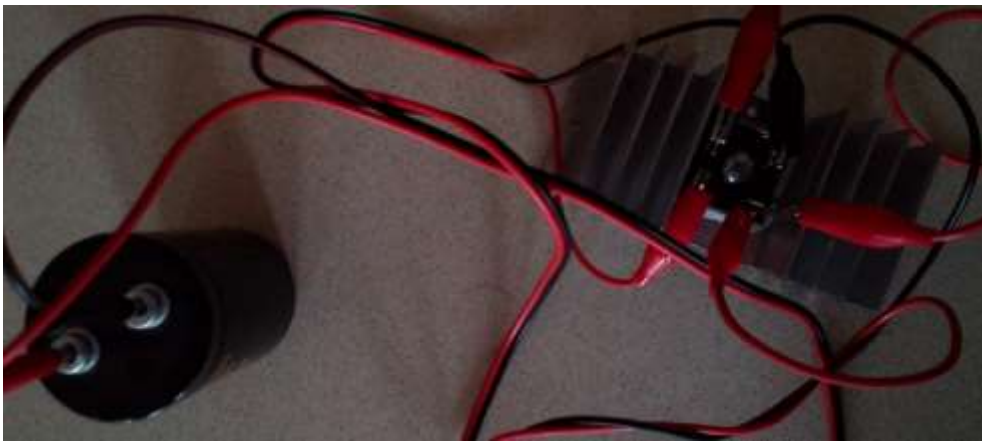
Şekil 2.6 : Köprü doğrultucu ve filtre kapasite.
