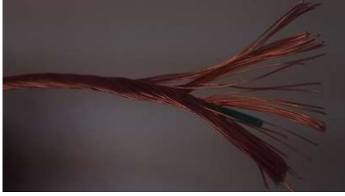
Şekil 3.6 : Projede kullanılan bükümlü ortasından yalıtkan geçen kablo.
