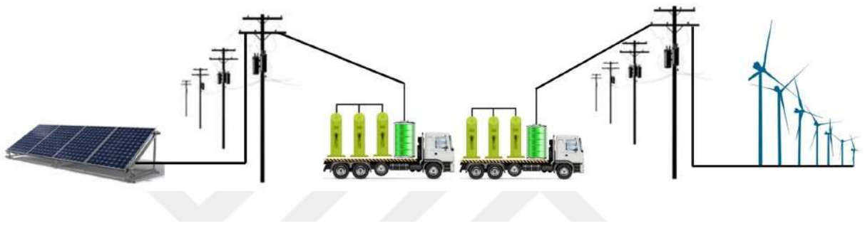
1) Mobil şarj istasyonu bataryasının YEK destekli elektrik şebekesi ile şarj edilmesi
