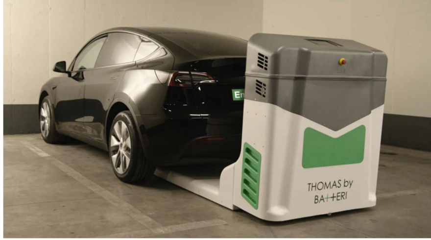
Şekil 5-5: Thomas şarj robotu [131]
