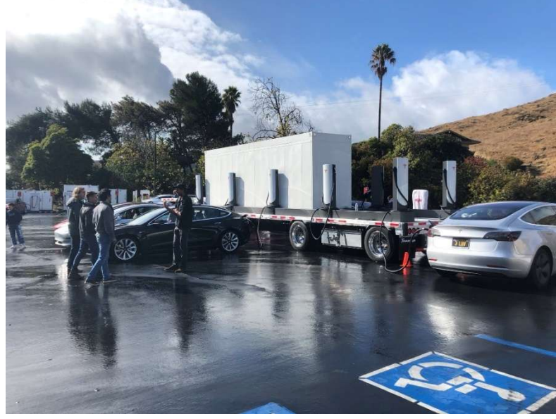
Şekil 4-5: Tesla bataryalı sisteme sahip mobil şarj istasyonu [84]
