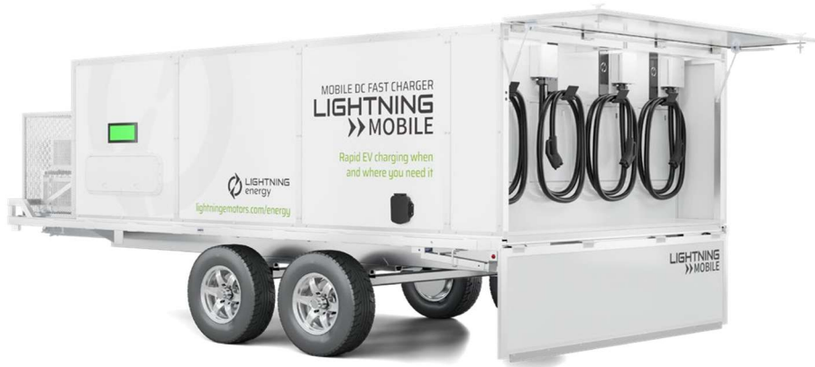
Şekil 5-17: Lightning Mobile mobil şarj istasyonu [150]
