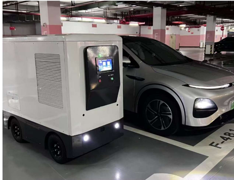
Şekil 5-28: Xiaofu yol kurtarma enerjisi EA otonom şarj robotu [173]
