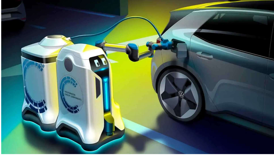
Şekil 5-27: Volkswagen otonom mobil şarj robotu [172]
