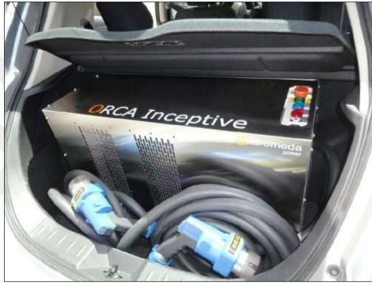
Şekil 5-3: ORCA Inceptive araç üstü hızlı şarj istasyonu [127]
