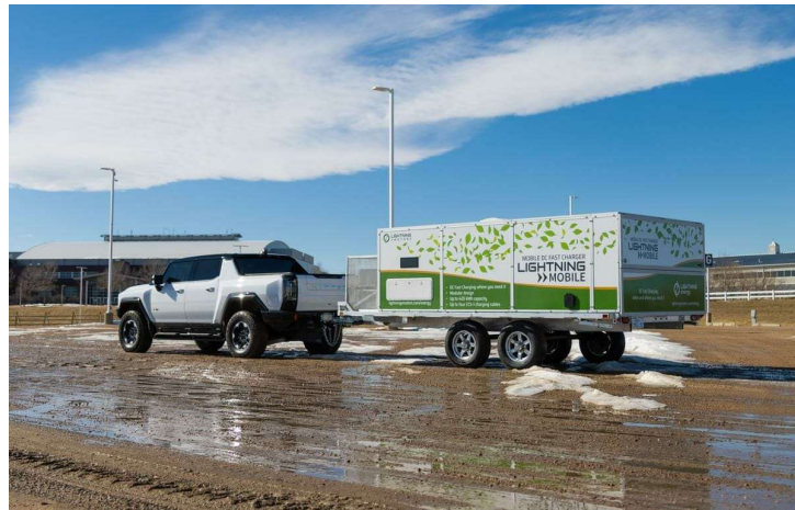
Şekil 4-3: Bataryanın römorkta taşındığı sistem [82]
