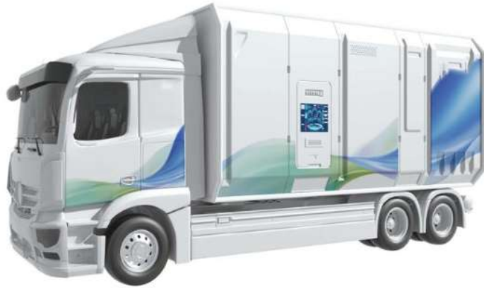
Şekil 5-2: Anari elektrikli araç mobil şarj sistemi [126]
