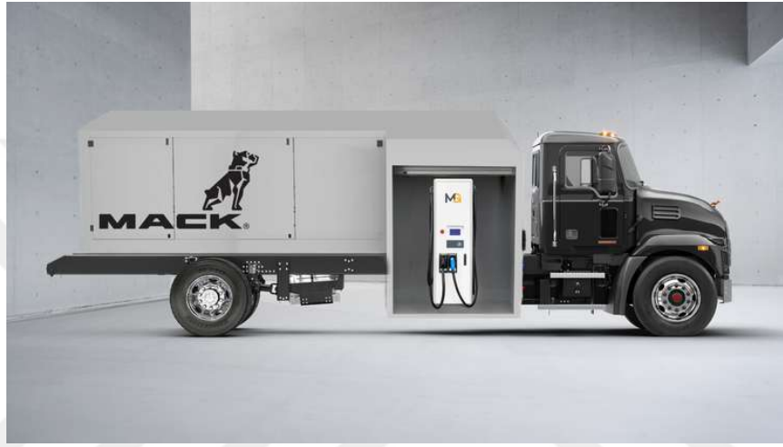
Şekil 5-18: Mack MD Electric şebeke dışı mobil şarj sistemi [151]
