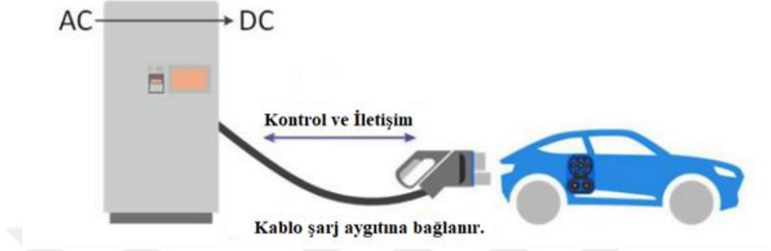
Şekil 4.10. Mod 3 şarj bağlantısı (Karapınar & Daldaban, 2022)
