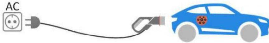
Şekil 4.6. Mod 1 şarj bağlantısı (Karapınar & Daldaban, 2022)
