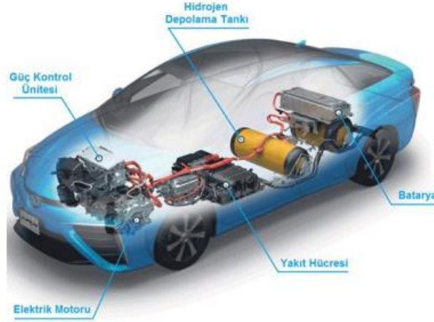
Şekil 3.6. YHEA iç yapısı (Özbay et al., 2020)
