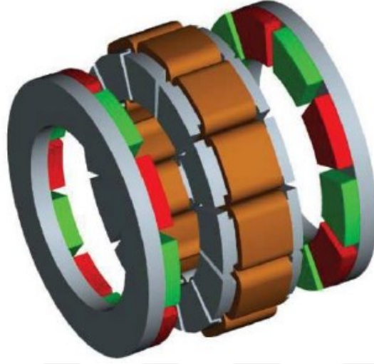
Şekil 3.7. Eksenel SMSM'nin yapısı [64].
