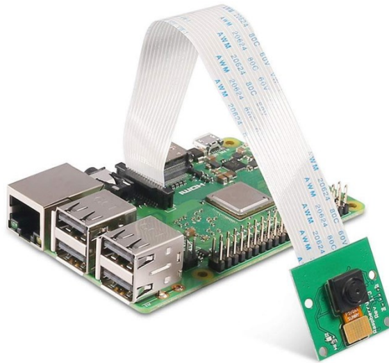
Şekil 7.30. Raspberry Pi ve kamera modülü
