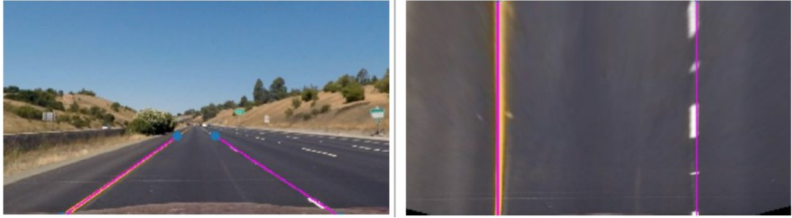
Şekil 7.37. Kaynak noktaları ve şerit çizgilerinin belirlenmesi
