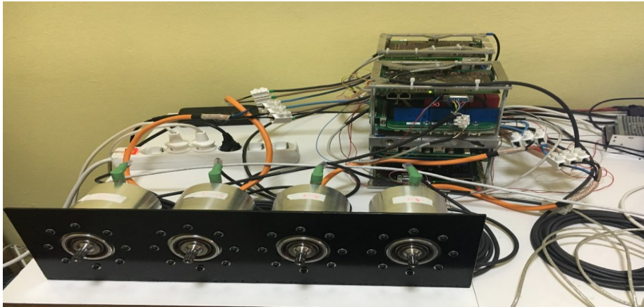
Şekil 6.13. Dört adet DSMSM ve sürücüleri
