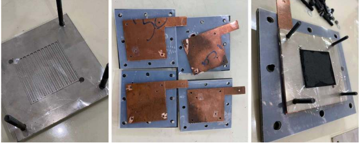
Şekil 5.16. Yakıt hücrelerin montaj aşamaları.
