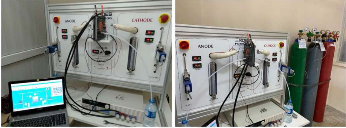
Şekil 5.18. Yakıt pili test düzeneği.
