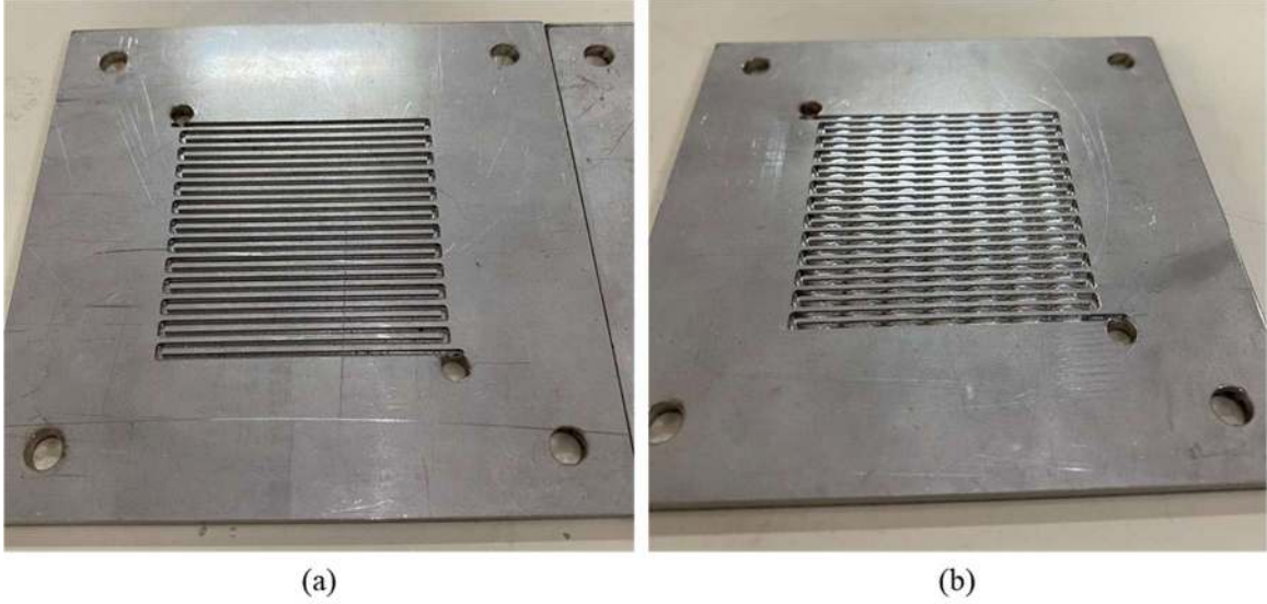
Şekil 5.13. CNC ile işlenen akış plakları, (a) serpantin, (b) engele sahip plaka.
