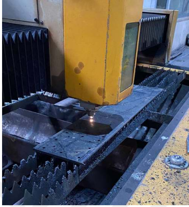
Şekil 5.14. Lazer kesim ile sıkıştırma plakalarının üretimi.
