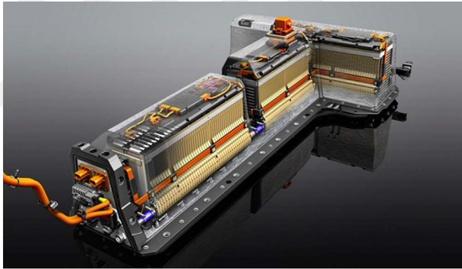
Şekil 1.2. Chevrolet Volt'un 16 kWh'lik Li-ion batarya paketi [23].
