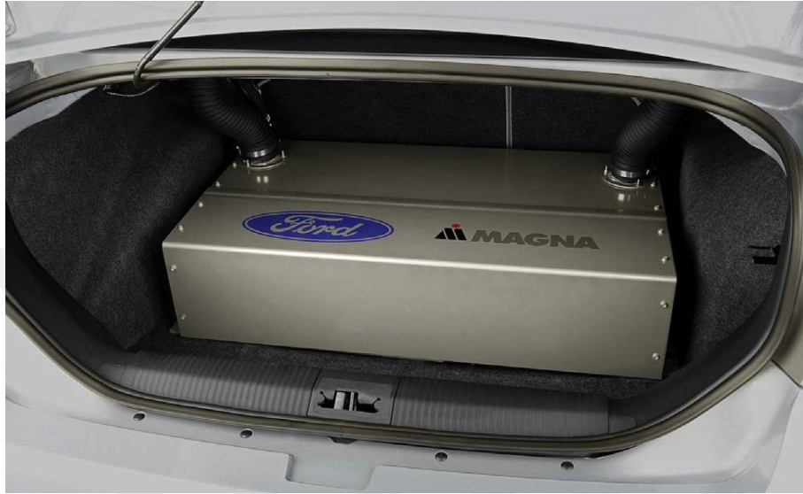
Şekil 1.3. Elektrikli Ford Focus'un 23 kWh'lik Li-ion batarya paketi [1].
