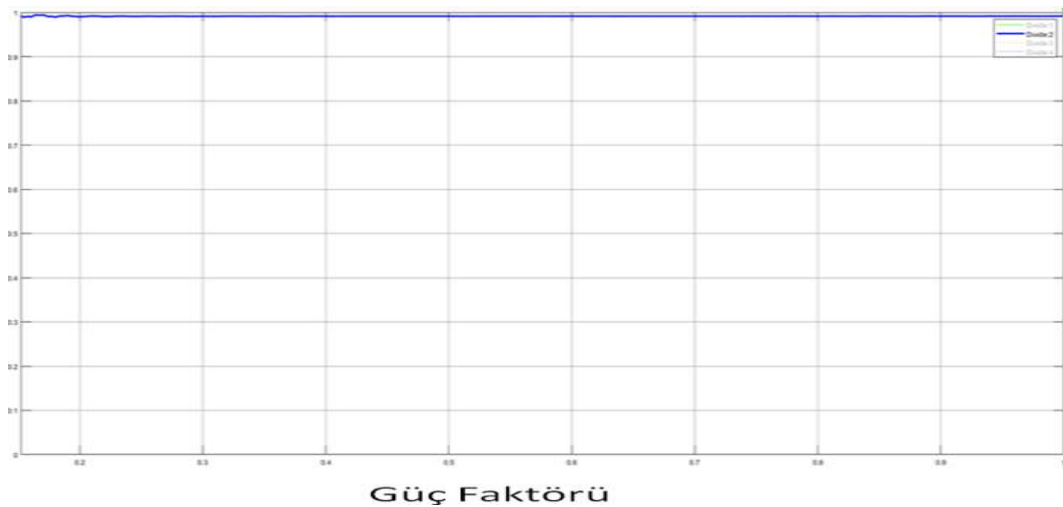
Şekil 9. 20. İki Yönlü Şarj Devresi için Güç Faktörü
