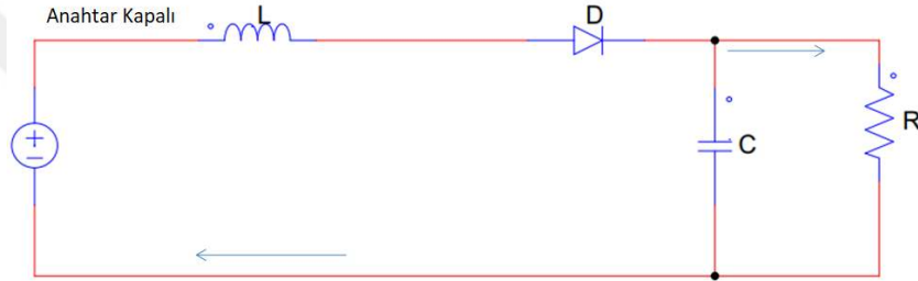
Şekil 8. 6. Yükseltici Tip DA-DA Dönüştürücü Yarı İletken Anahtarın İletim Durumu
