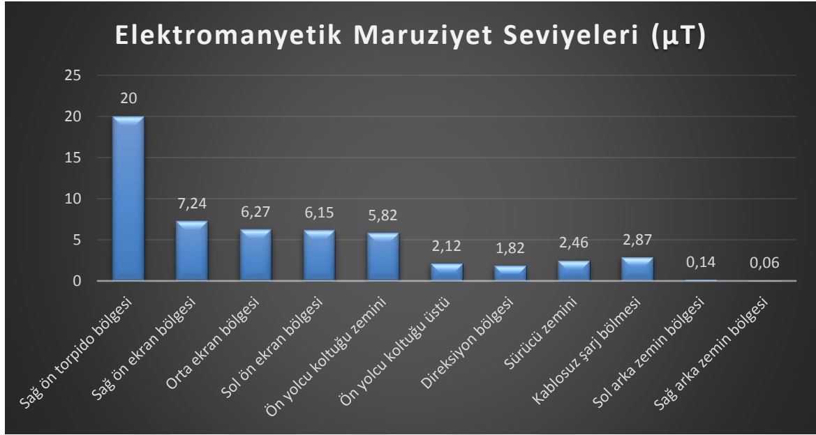
Şekil 4.12: TOGG Tx10 aracının statik durumda araç içi yaydığı elektromanyetik maruziyet seviyeleri.
