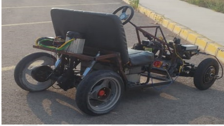
Resim 3.1 İmalatı yapılan elektrikli aracın arka motor bağlantısı ve genel görünümü.
