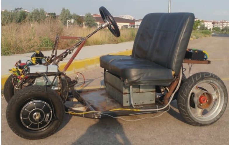
Resim 3.2 İmalatı yapılan elektrikli aracın yandan görünümü.
