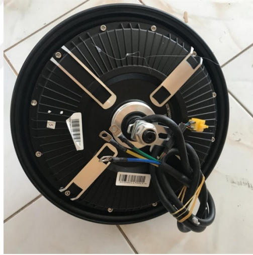
Resim 3.5 Ön tekerleklerin tahriki için kullanılan 1,2 kW elektrik motoru.
