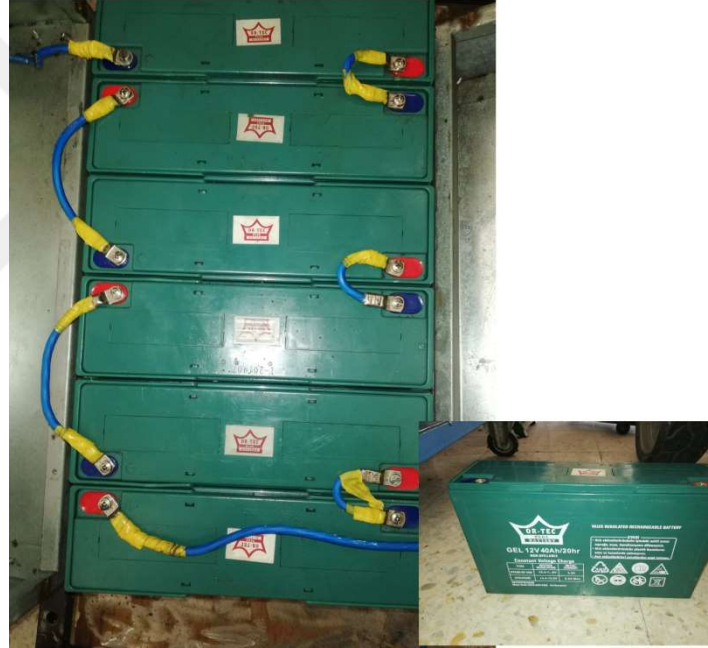
Resim 3.7 Taşıtta kullanılan bataryalar.
