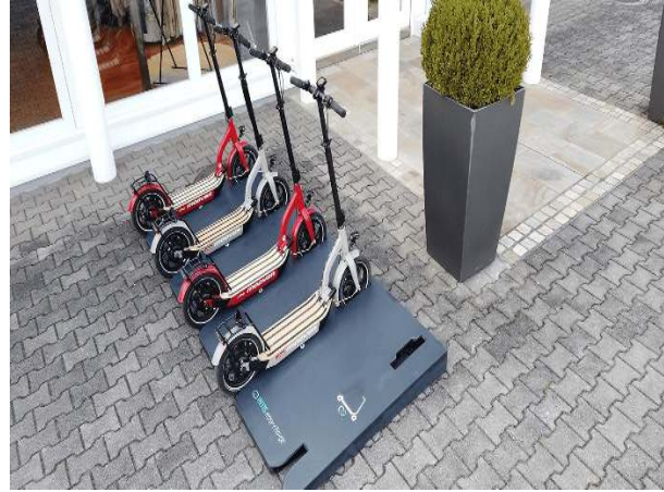
Şekil 1.2. Elektrikli scooter üzerinde kablosuz şarj çalışması [2].
