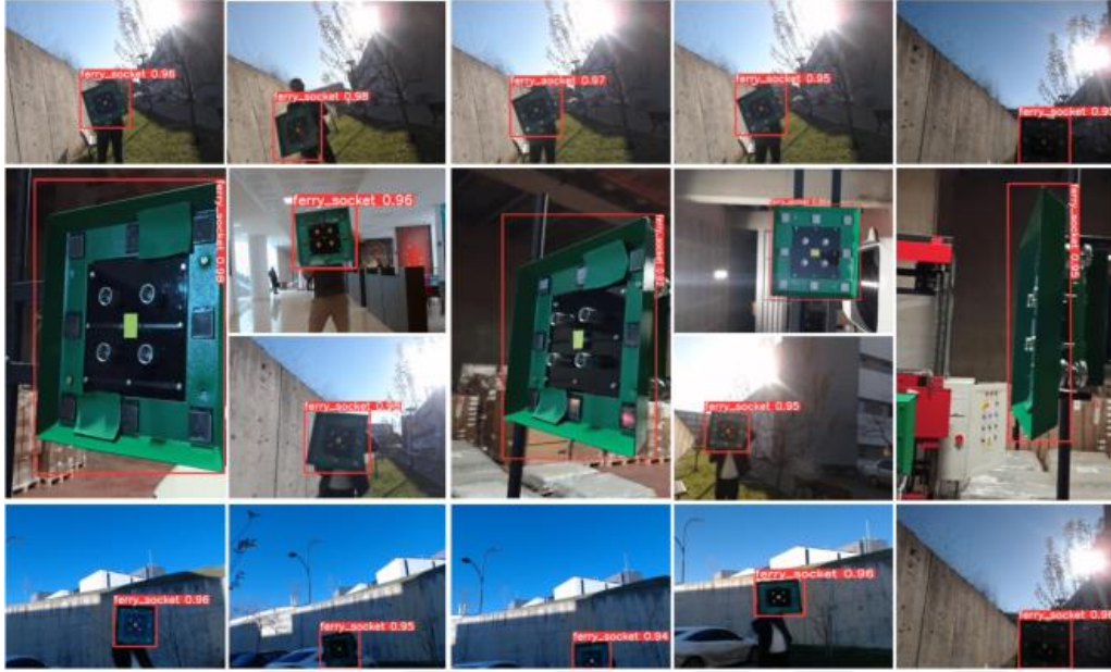
řekil 4.3. YOLOv5 tabanlı řarj soketi tespit modlnn gerek ortam grntleri zerindeki tespit sonuları.
