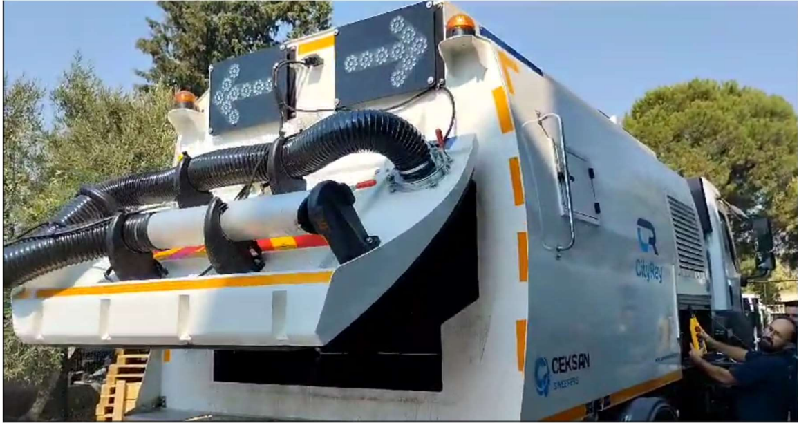
Şekil 5.9. Lamba ve çöp haznesi fonksiyon testleri
