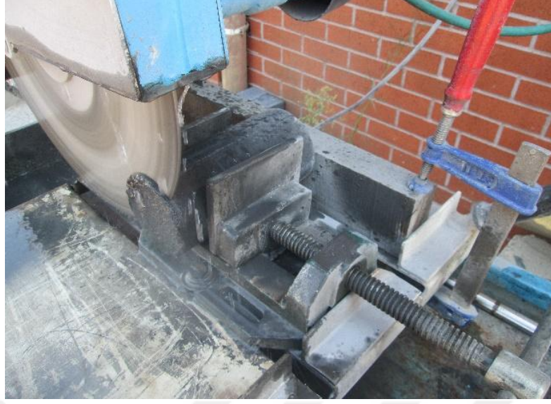
Şekil 3.11. Silindir numunelerin pürz  taraflarının kesilmesi.
