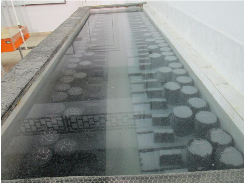
Şekil 3.10. Numunelerin kür havuzunda yerleştirilmesi.
