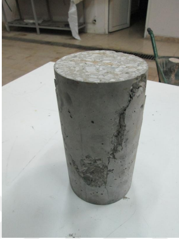
Şekil A.3. Basınç numunelerin kırılma şekli.
