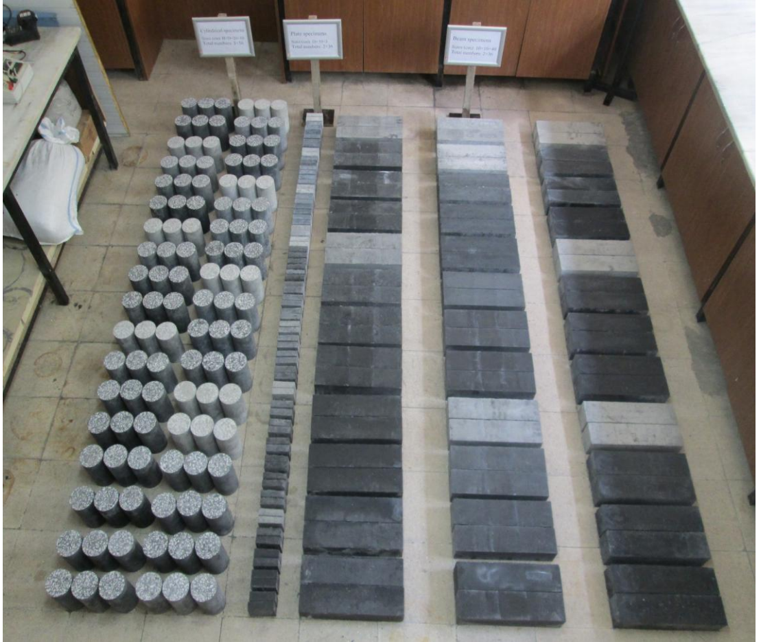
Şekil 3.12. Numunelerin oda sıcaklığında kurutulması.
