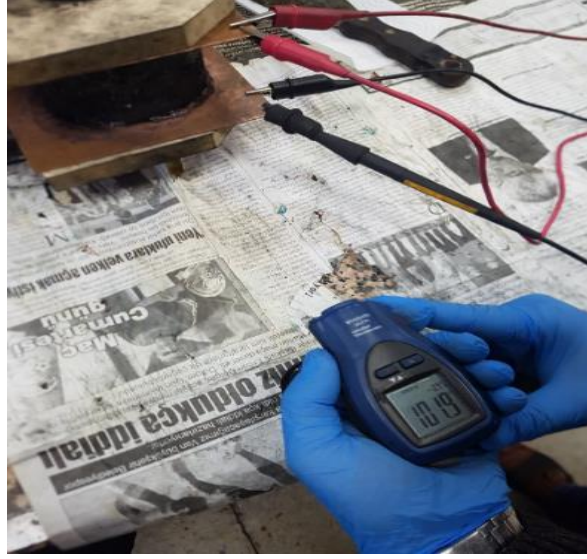
Resim 3.8 İnfrared termometre ile numunelerdeki sıcaklık değişimlerinin ölçülmesi
