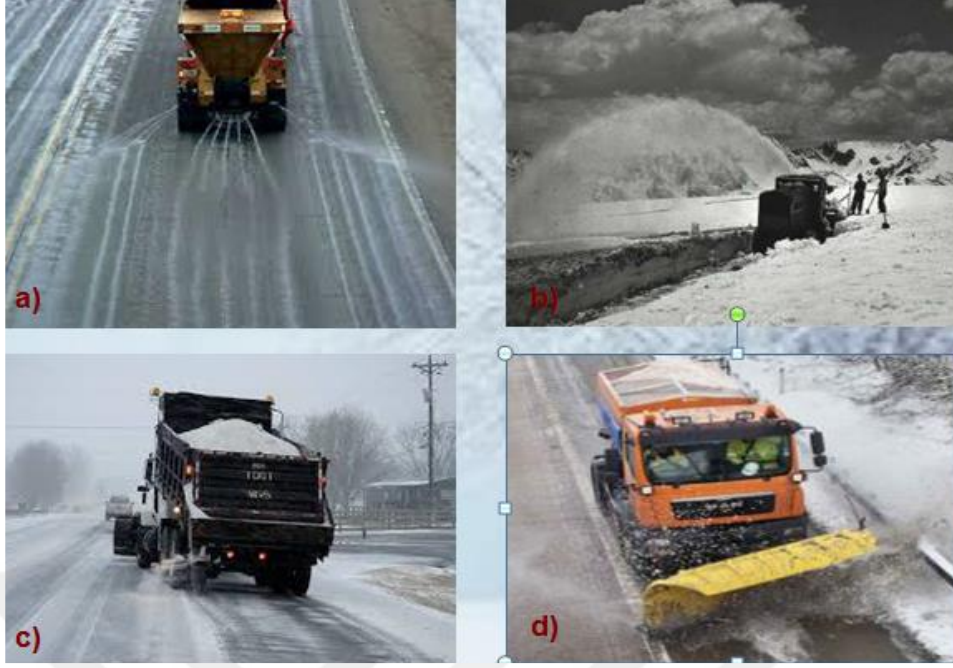
Resim 2.1 Buzlanma ile mücadelede pasif yöntemler, a) Solvent püskürtme aracı b) Rotatif kar üfleme aracı c) Karayolu tuzlama çalışması d) Kar Sıyrıcı (Gürer 2014).
