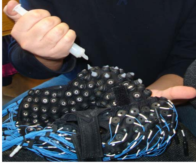
Resim 9.8. EEG başlığının kayda hazırlanması (jelleme işlemi).
