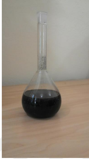
Şekil 4.1. Hazırlanan takviyesiz MgB 2 kaplama çözeltisi
