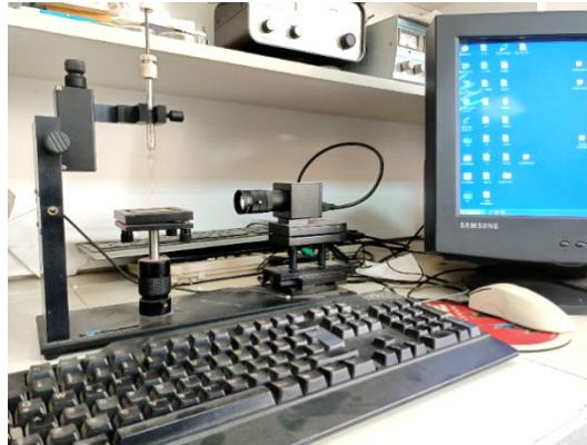
Şekil 3.11. Optik temas açısı analiz cihazı
