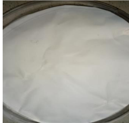
Şekil 3.4 Toplayıcı plaka yüzeyinde biriken PVDFHFPAD7 kodlu PVDF-HFP nanofiber yapının fotoğrafı (Kişisel arşiv, 2018)
