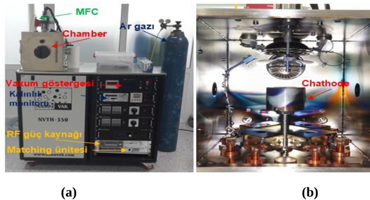
Şekil 2.2 Saçtırma sistemi (a) ve sistemin üzerindeki vakum odasının iç görüntüsünün fotoğrafı (b) (Kişisel arşiv, 2018)
