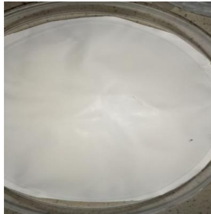
Şekil 3.1 Toplayıcı plaka yüzeyinde biriken PMMATD13 kodlu PMMA nanofiber yapının fotoğrafı (Kişisel arşiv, 2018)
