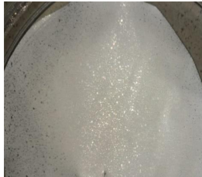
Şekil 3.9 Toplayıcı plaka yüzeyinde biriken PA6F2 kodlu PA6 yapının fotoğrafı (Kişisel arşiv, 2018)
