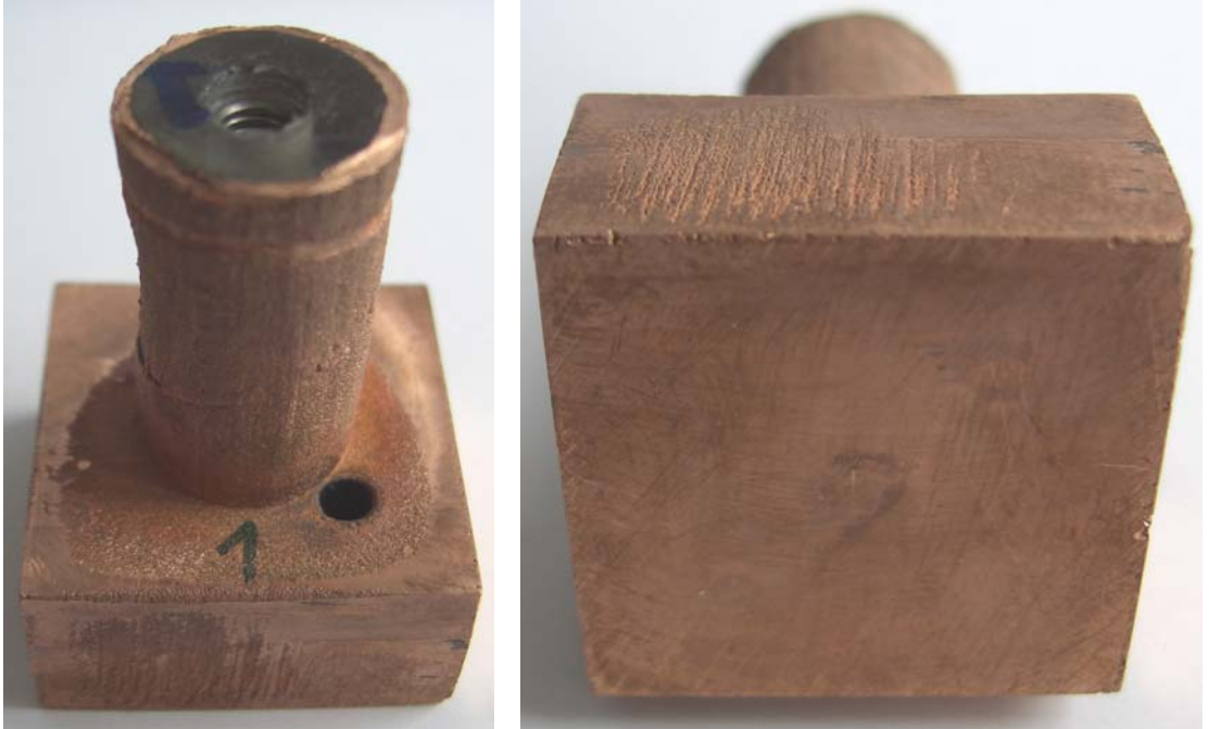
Resim 5.12. Soğutma kanalsız SL elektrodun işlendikten sonraki görünümü
