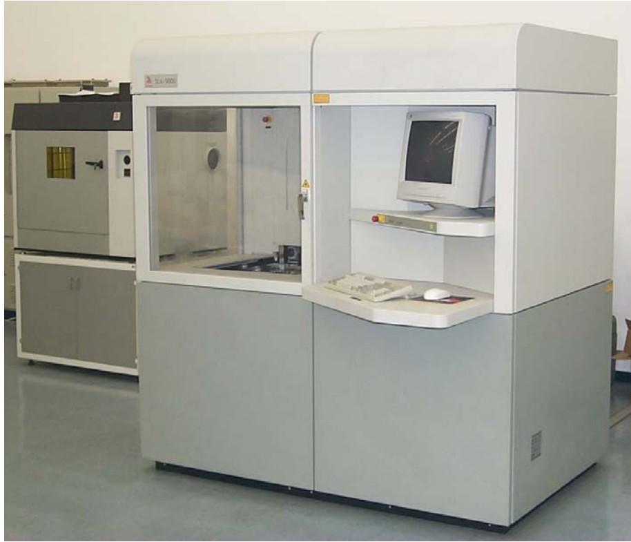
Resim 5.2. 3D Systems SLA5000 stereolitografi tezgahı ve kür fırını (ASELSAN-MGEO)
