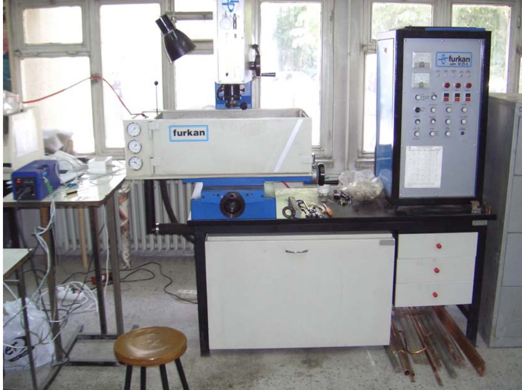
Resim 5.3. Tez çalışmasında kullanılan EEİ tezgahı Furkan EDM M25A
