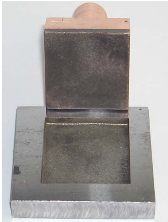
Resim 6.1. Bir numaralı deney sonrası bakır elektrot (D1) ve işparçası
