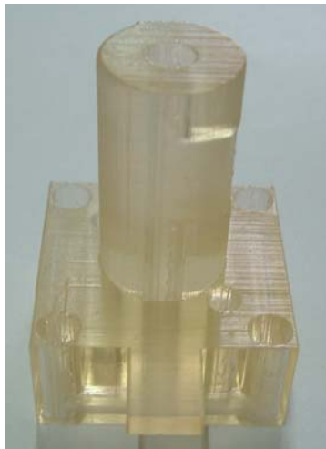
Resim 5.6. Kürü tamamlanmış SL elektrotlar
