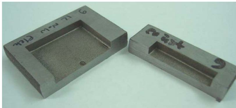
Resim 5.19. Yüzey pürüzlülüğü ölçümü için kesilmiş işparçası
