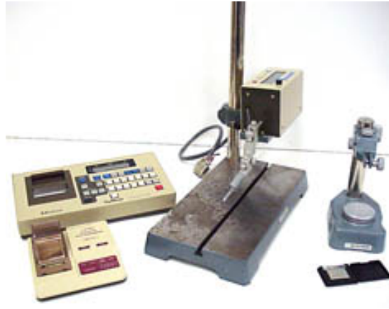
Resim 5.18. Yüzey pürüzlülüğü ölçüm cihazı
