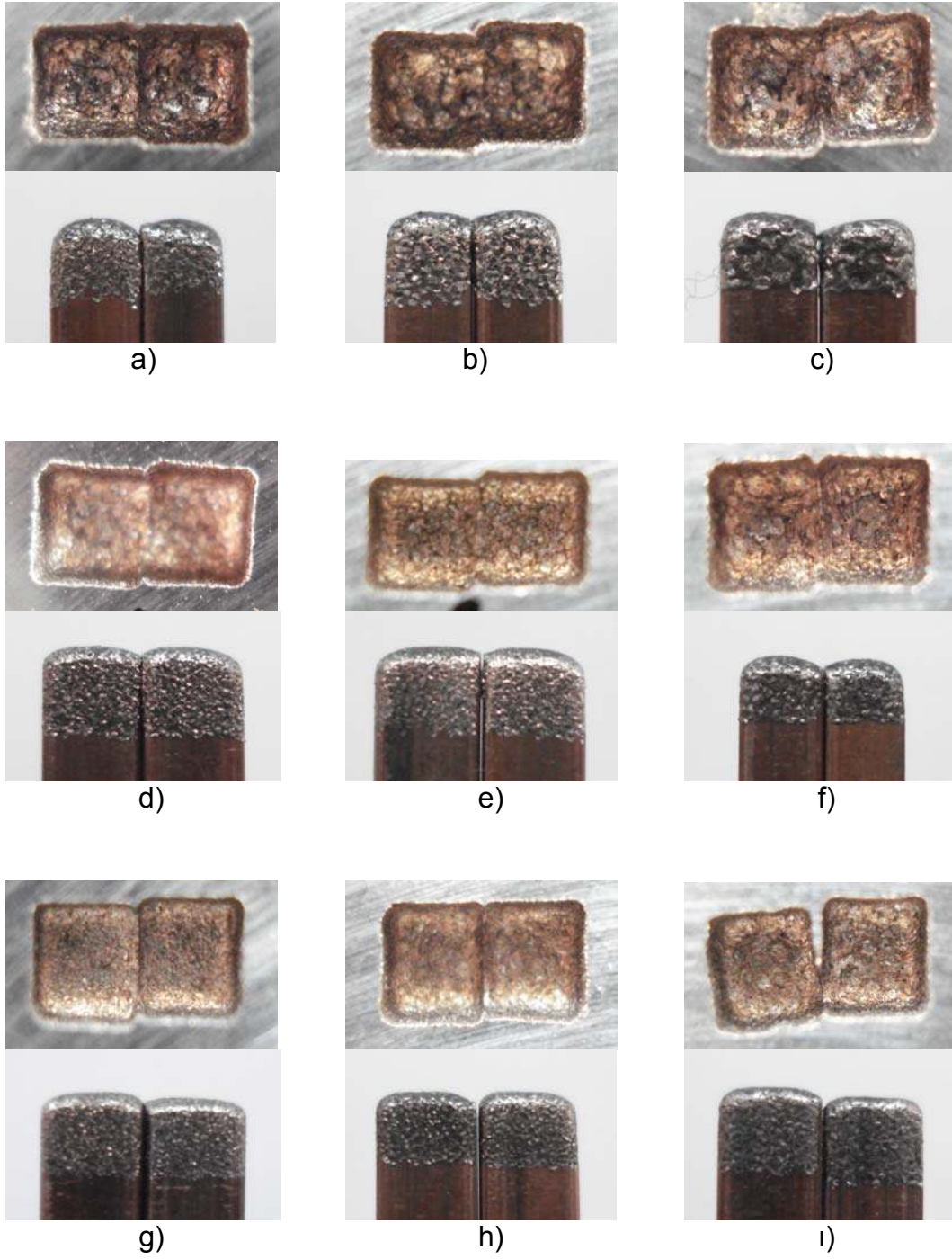
Resim 6.2. İki tel ile aşındırılan işparçaları ve aşınan tellerin fotoğrafları a) 25 A, 25 \mu s, b) 25 A, 50 \mu s, c) 25 A, 100 \mu s, d) 12 A, 25 \mu s, e) 12 A, 50 \mu s, f) 12 A, 100 \mu s, g) 6 A, 25 \mu s, h) 6 A, 50 \mu s ve ı) 6 A, 100 \mu s
