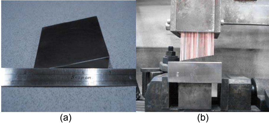
Resim 5.5. 11° açılı tel dizme mastarı a) Master b) Açılı dizilmiş teller
