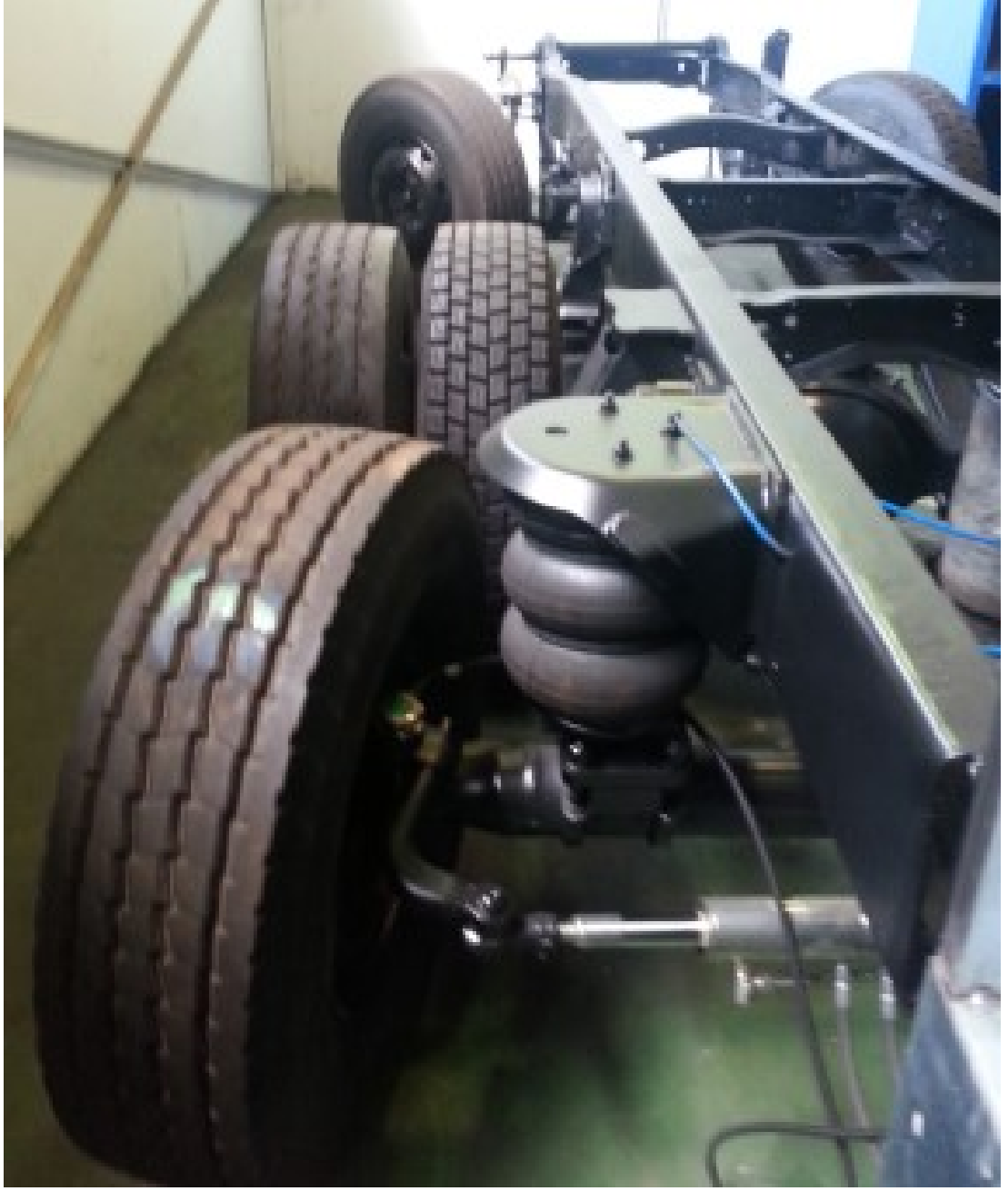
Şekil 4.26 Araç üzerinde yönlendirilebilir ilave dingilin maksimum açılı durumu
