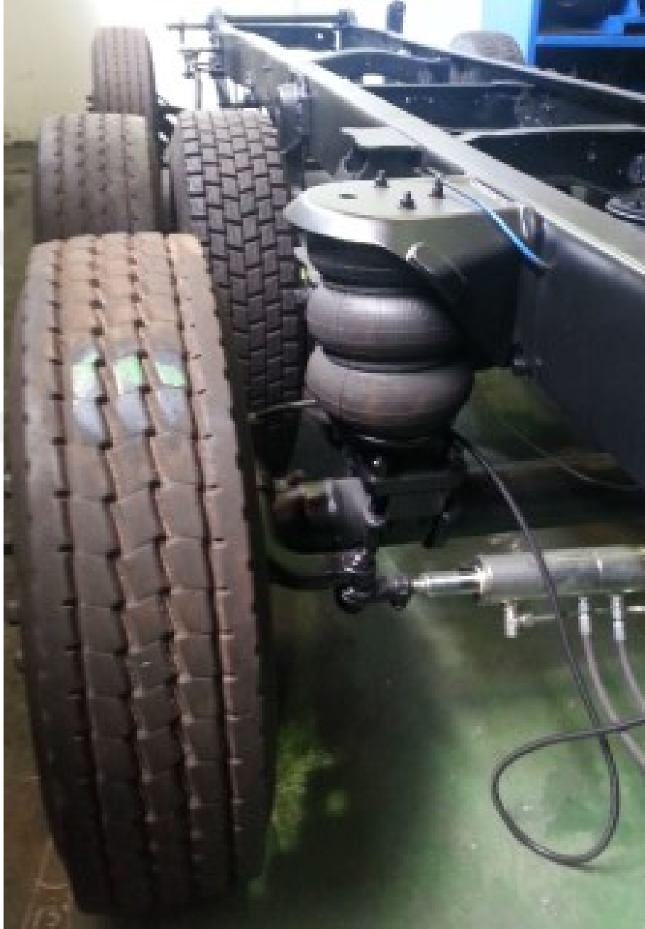
Şekil 4.25 Araç üzerinde yönlendirilebilir ilave dingil sistemi
