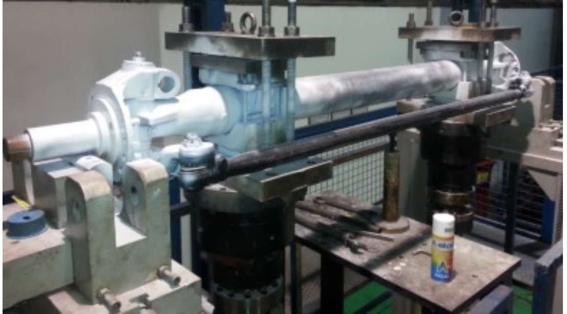
Şekil 4.24 Düşey yorulma testine bağlanmış yönlendirilebilir ilave dingil
