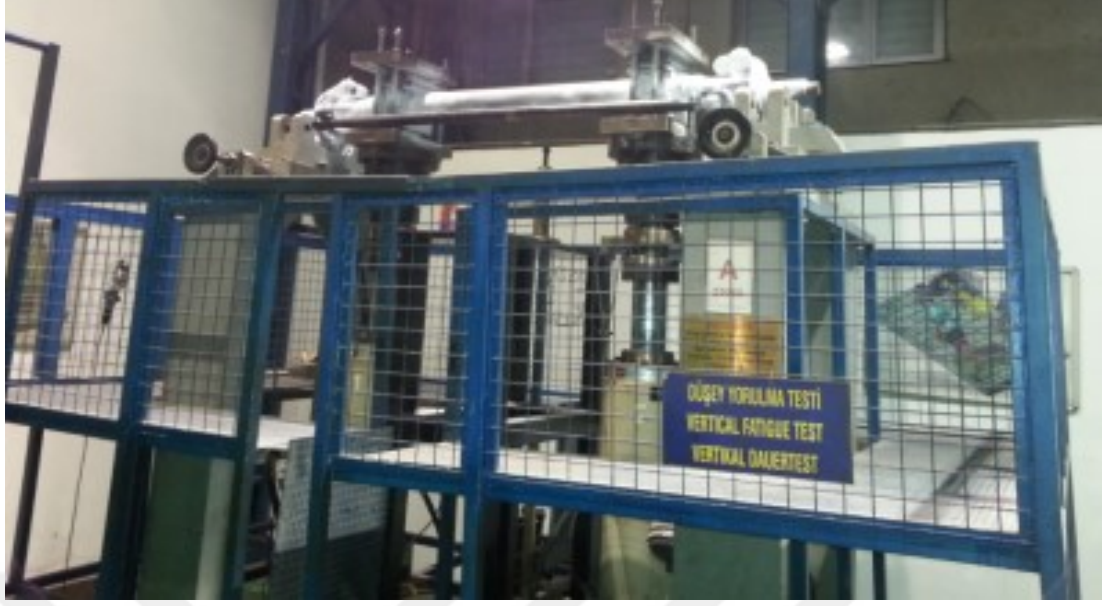
Şekil 4.23 Düşey yorulma testine bağlanmış yönlendirilebilir ilave dingil
