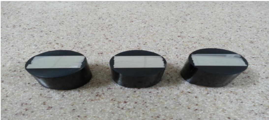
Resim 3.9 Numunelerin Sıcak Kalıplama Bakalite Alınma.
