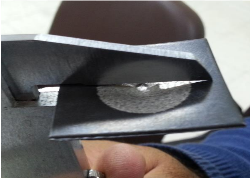
Resim 4.22 AISI 1008 Çeliği Kaplama Yüzeyi Serbest Deformasyon İz Genişliği.
