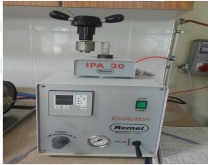
Resim 3.8 Numunelerin Sıcak Kalıplama Bakalite Alınma İşlemi.
