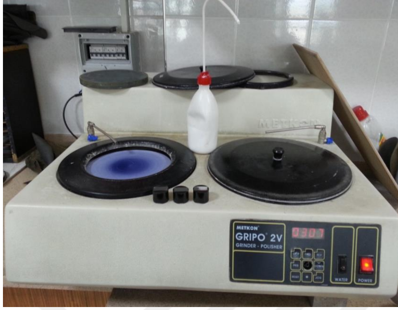
Resim 3.12 Mikro Yapı Analizi İçin Cuha ve Alimüna ile Parlatma İşlemi.
