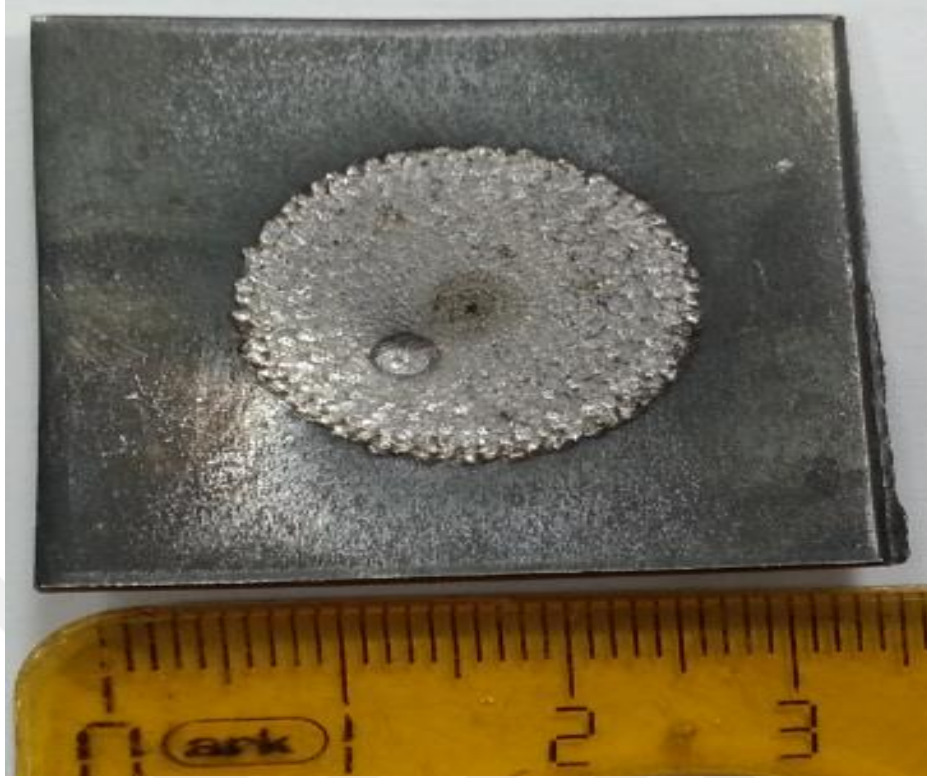
Resim 4.19 AISI 1008 Çeliği Üzerine W Kaplama Serbest Deformasyon İzi.
