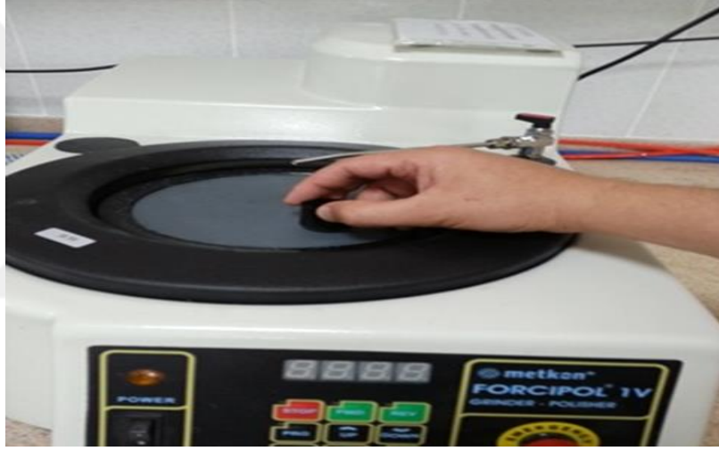
Resim 3.10 Mikro Yapı Analizi İçin Zımparalama İşlemi.
