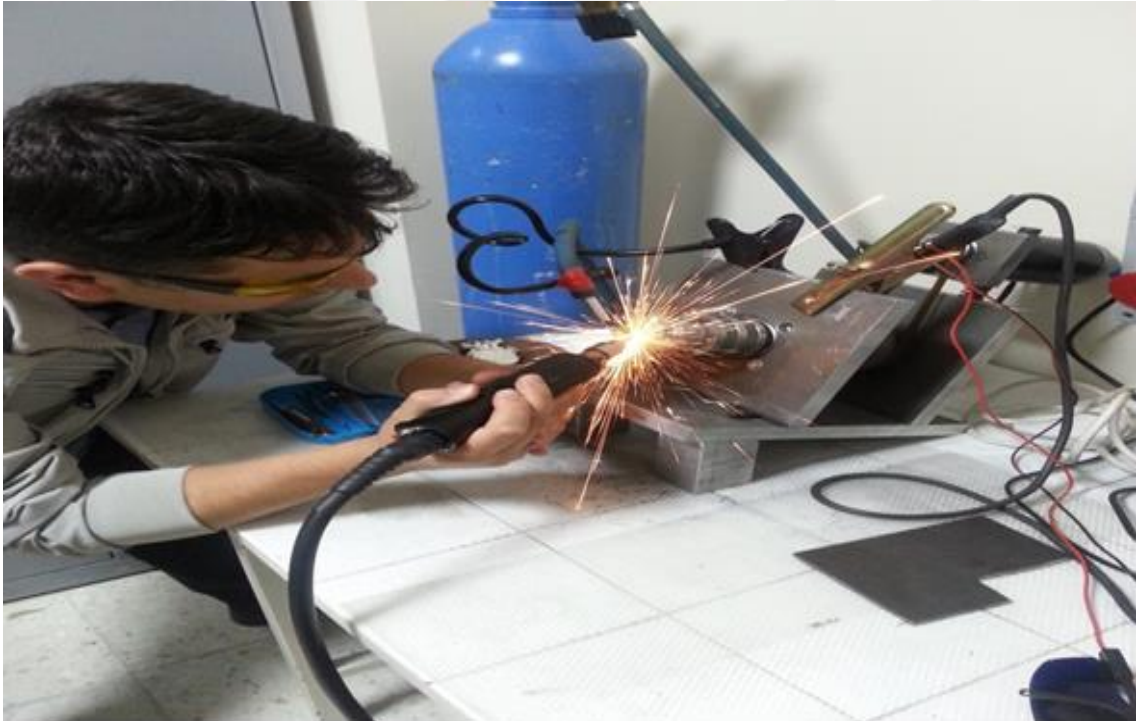
Resim 2.2 ESD Yöntemi ile AISI 1008 Malzeme Yüzeyi Tungsten (W), Tungsten Karbür(WC) ve Alaşımlı Çelik ile Kaplama Yöntemi.
