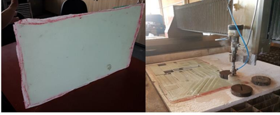
Şekil 3.4. Saf cam/epoksi kompozit levha ve su jeti ile kesilmesi
