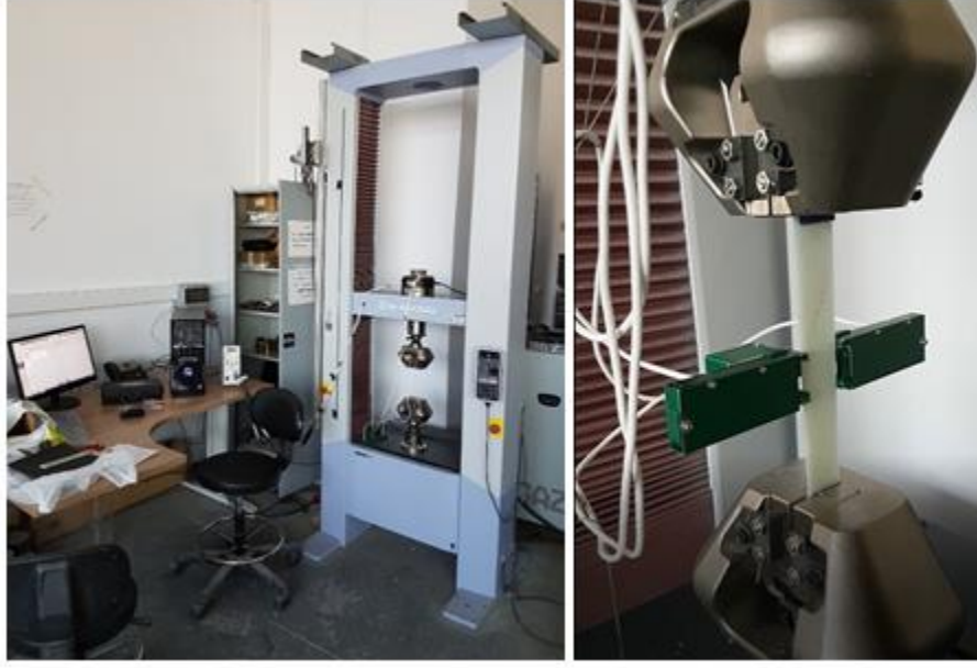
Şekil 3.6. Universal çekme basma test cihazı ve clip-on ekstensometre
