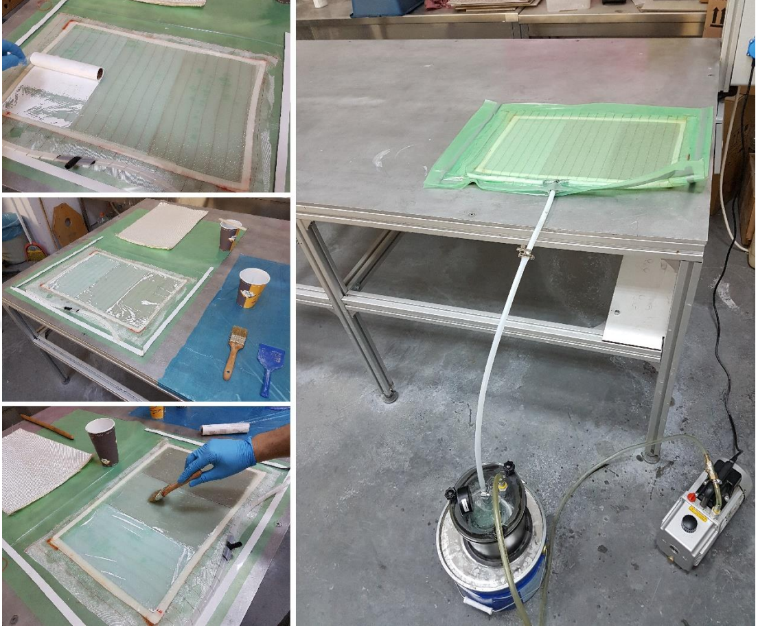
Şekil 3.3. Vakum destekli el yatırma metoduyla nanofiber takviyeli cam/epoksi kompozit levha üretimi
