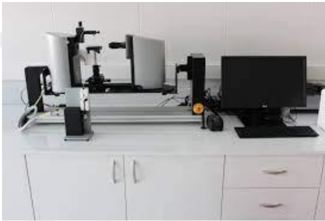
Şekil 3. 6. Temas Açısı ve Yüzey Gerilimi Ölçüm Cihazı (Attension Theta)
