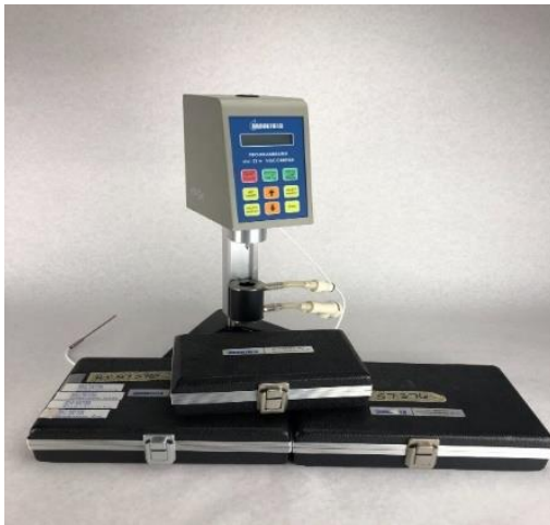
Şekil 3. 3. Brookfield LVDV-II + Viscometer
